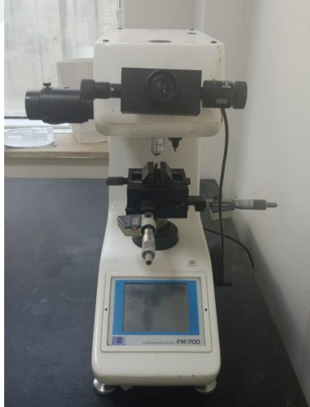
Şekil 26. Future-Tech FM-700 mikro sertlik ölçüm cihazı
