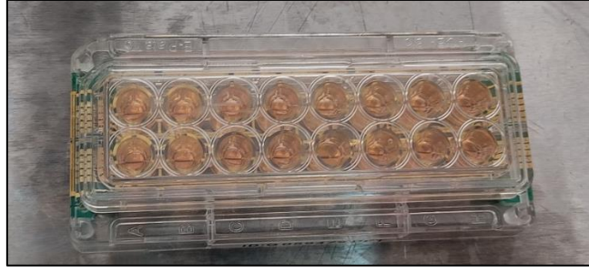
Şekil 11. Hücre Süspansiyonu Eklenmiş 16 Kuyucuklu E-Plate
