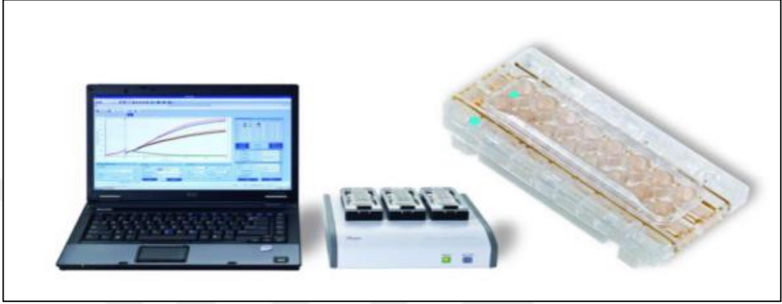
Şekil 6. xCELLigence RTCA cihazı ve E-plate
