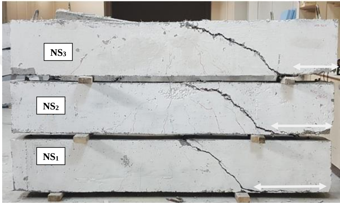
Şekil 4.2. NS grubu betonarme kirişleri için çatlak desenleri; (NS 1 ) = %0; (NS 2 ) = %0,5; (NS 3 ) = %1,5 plastik fiber katkılıdır.
