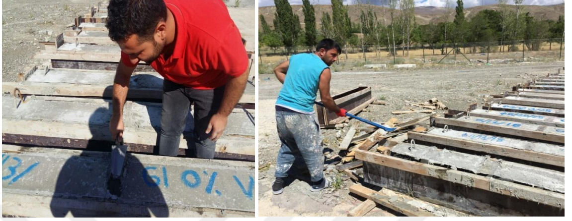
Şekil 3.15. Betonarme kiriş numunelerinde tamir harcı ile tadilat yapılma işlemi ve kalıpların sökülmesi.
