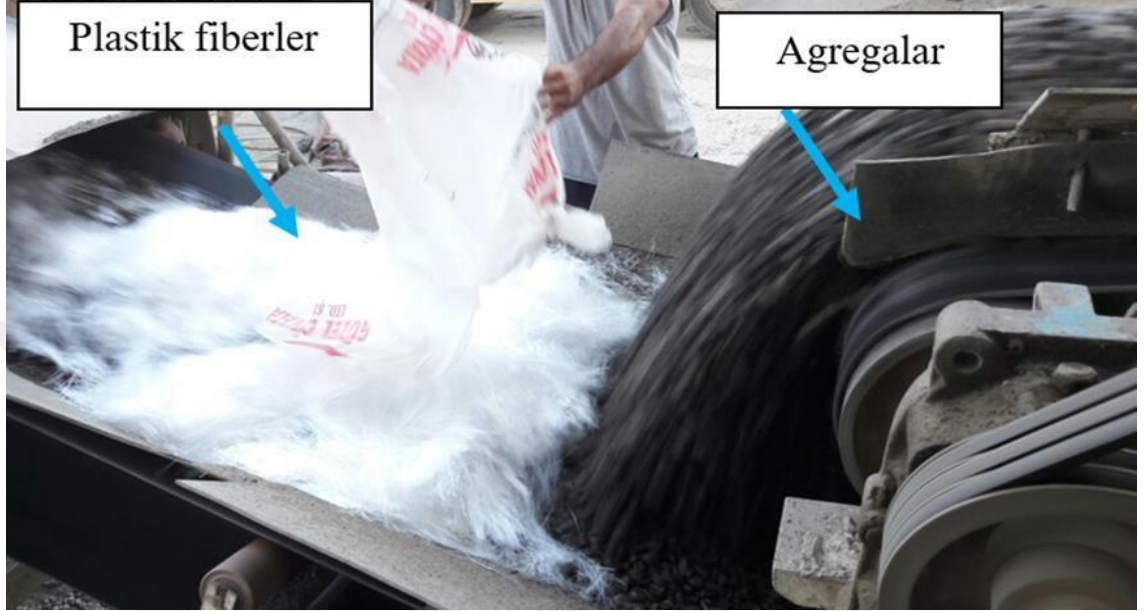
řekil 3.9. Beton santraline gtrlen plastik fiberlerin belirlenen oranlarda betona katılma iřlemi.
