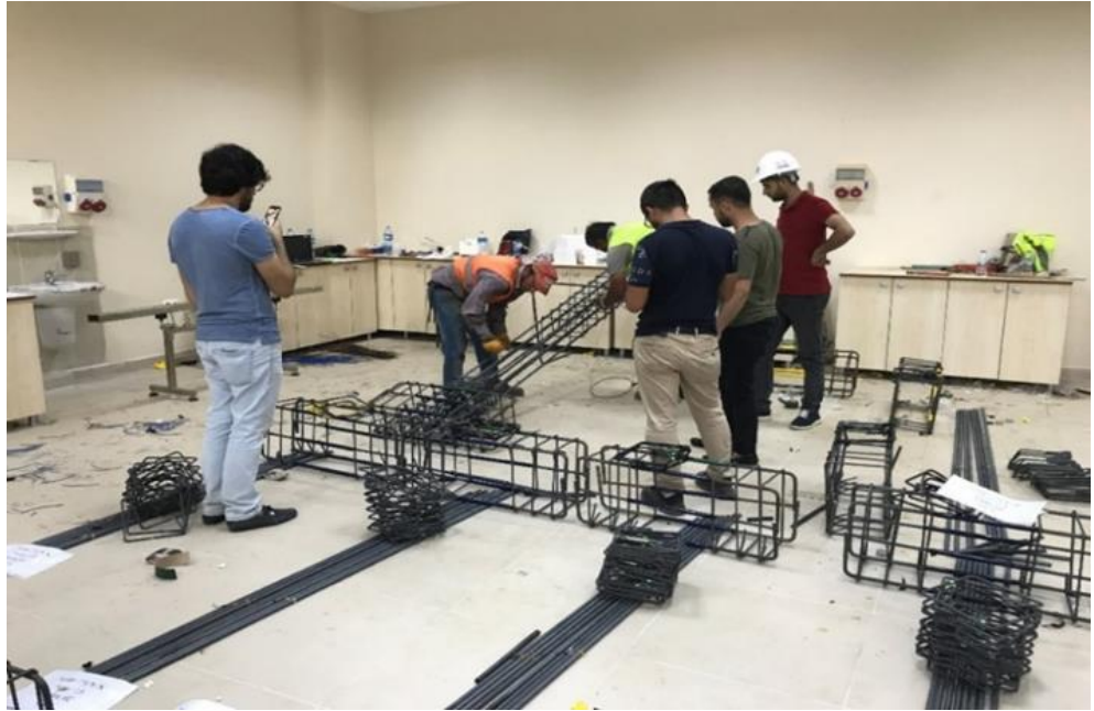
Şekil 4.9. Bakış açısına göre boyuna donatılarının bağlanması.
