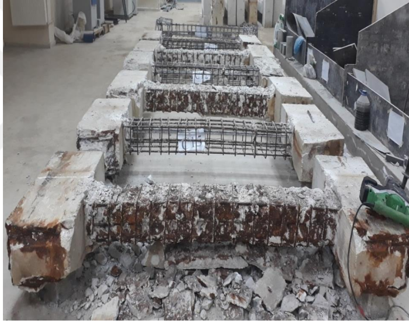
Şekil 5.1. Yükleme deneyleri sonrası betonarme kolonlarının kırılması.
