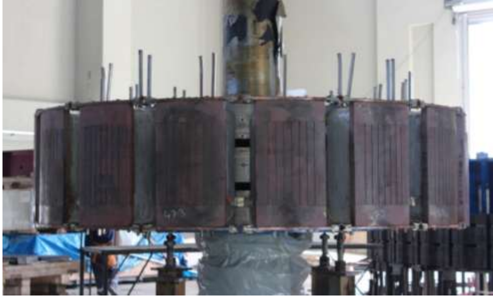
Şekil.22 Örnek bir kamalı bağlantı ile sabitlenmiş rotor imalatı
