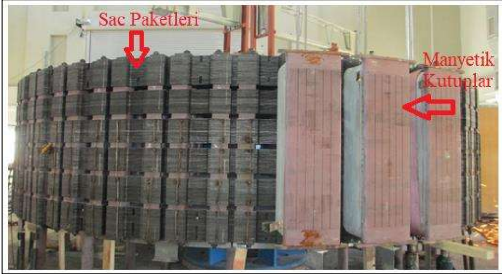
Şekil.18 Örnek bir çıkık kutuplu rotor yapısı (Bağıştaş I HES Santrali)
