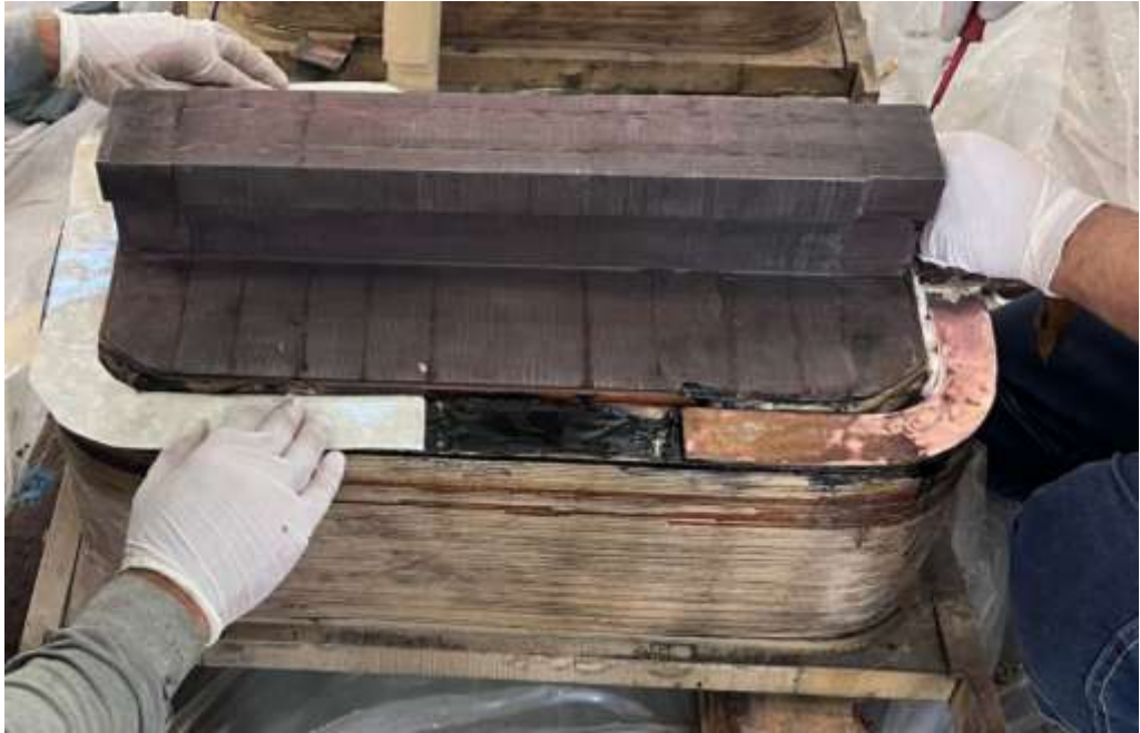
Şekil 24. Örnek bir dikdörtgen kesitli bakır iletkene sahip rotor manyetik kutbu görüntüsü (Bağıştaş I HES)
