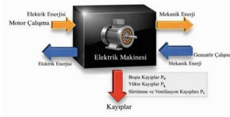
Şekil 8. Elektrik makinelerinde elektromekanik enerji dönüşümü
