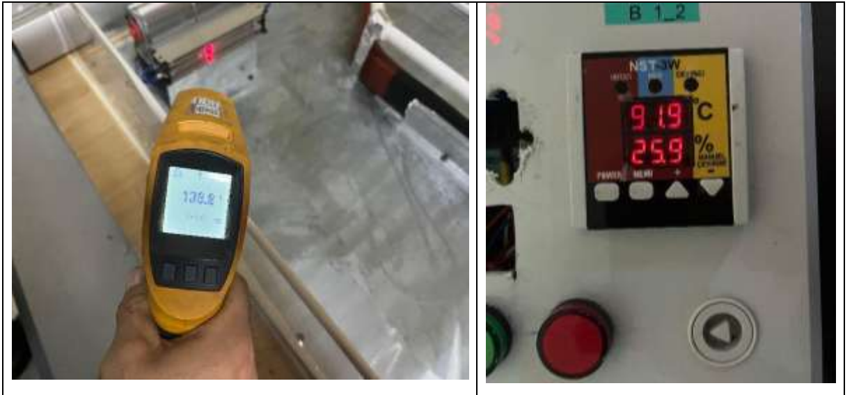
Şekil 53. Sargıların kurutulma işlemi esnasında alınan ölçümler
