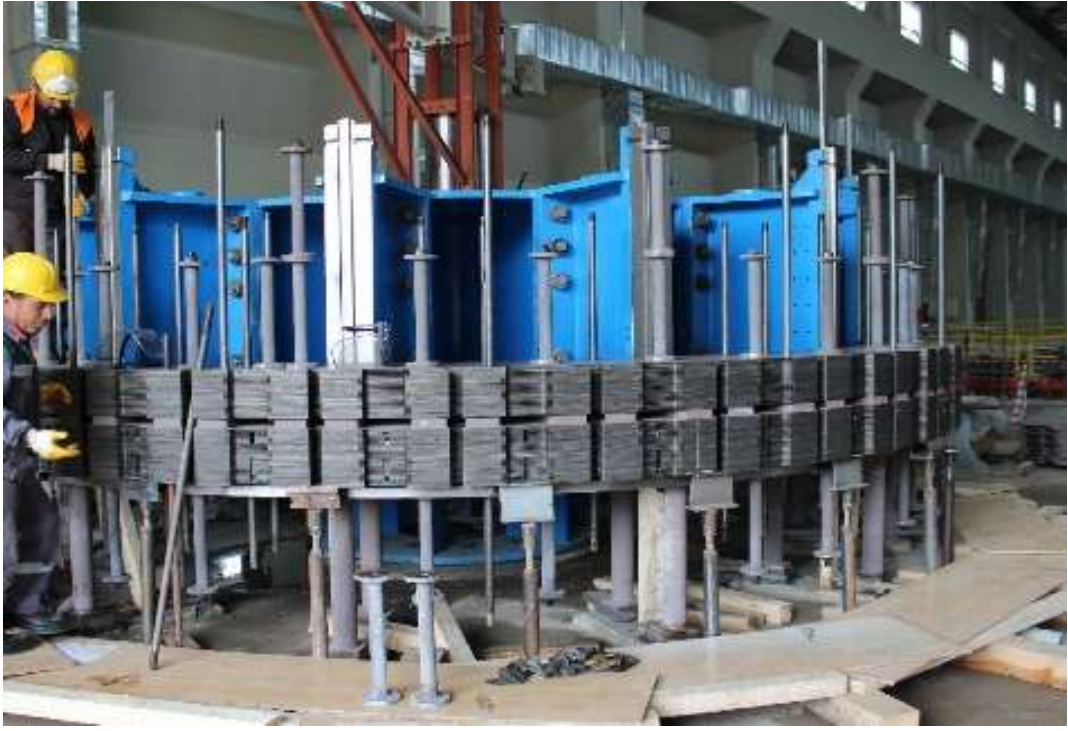
Şekil.19 Rotor laminasyon sacları ve imalat aşaması
