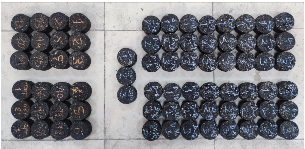
Şekil 25. Marshall stabilite ve akma deneyi uygulanan numuneler
