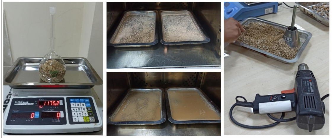
Şekil 12. İnce agrega deneyi görselleri
