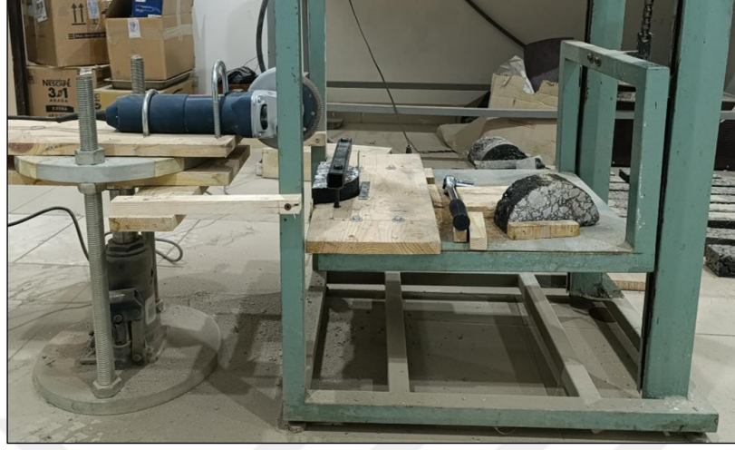
Şekil 28. Çentik açmak için kullanılan düzenek
