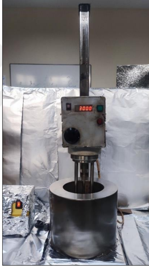
Şekil 14. Yüksek hızlı mikser ve ısıtıcı kap
