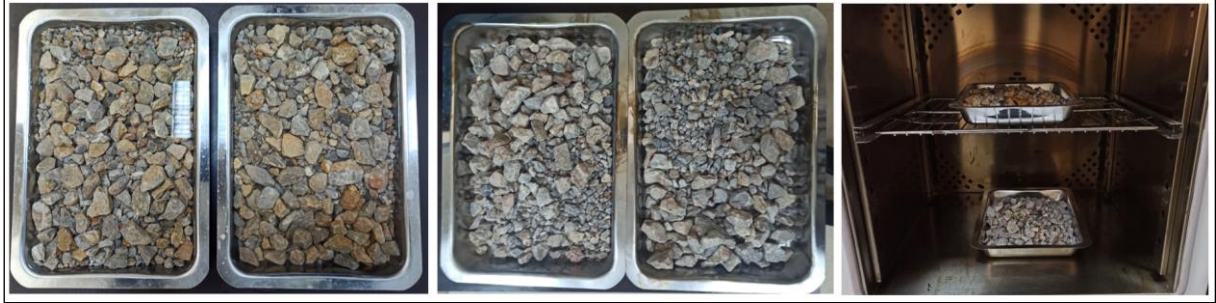
Şekil 11. Kaba agrega özgül ağırlık deney numuneleri
