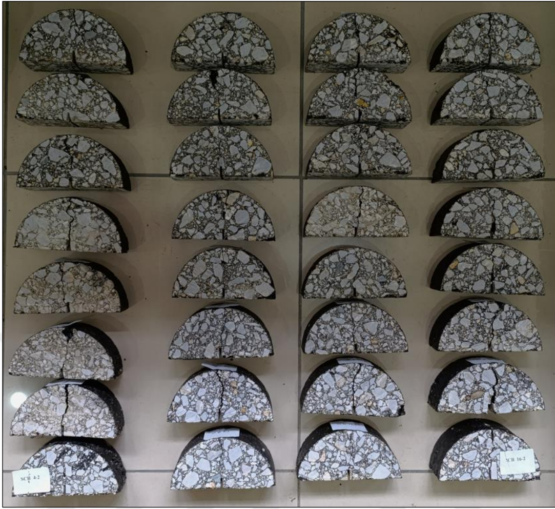
Şekil 48. -20°C Sıcaklıkta kırılan SCB numuneleri
