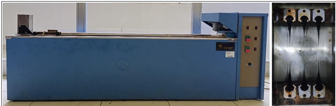
Şekil 20. Elastik geri dönme deney cihazı ve numuneleri
