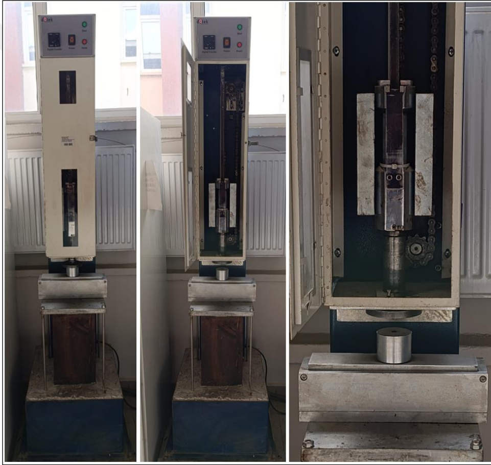
Şekil 33. Kiriş numune kompaktörü
