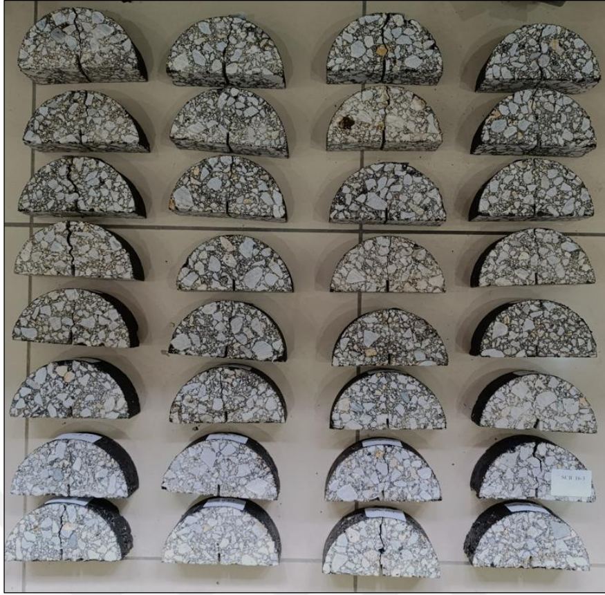
Şekil 46. 0°C Sıcaklıkta kırılan SCB numuneleri
