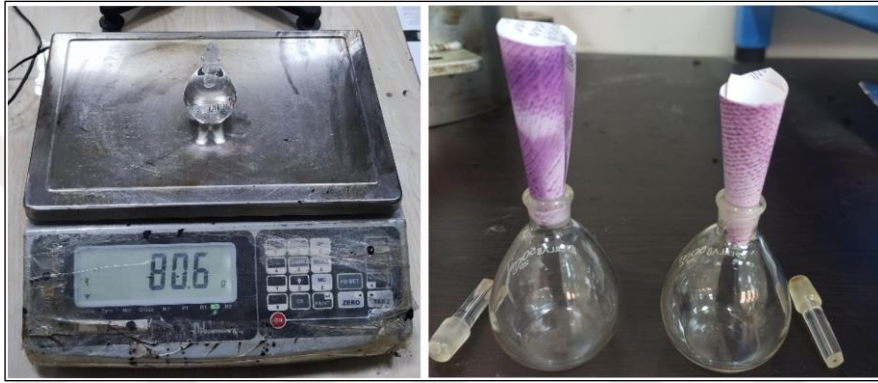
Şekil 15. Piknometre ve tartım işlemi
