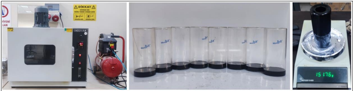
Şekil 19. RTFOT cihazı ve numuneleri
