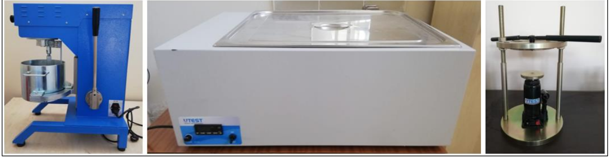
Şekil 22. Çalışmada kullanılan mikser, su banyosu ve numune krikosu
