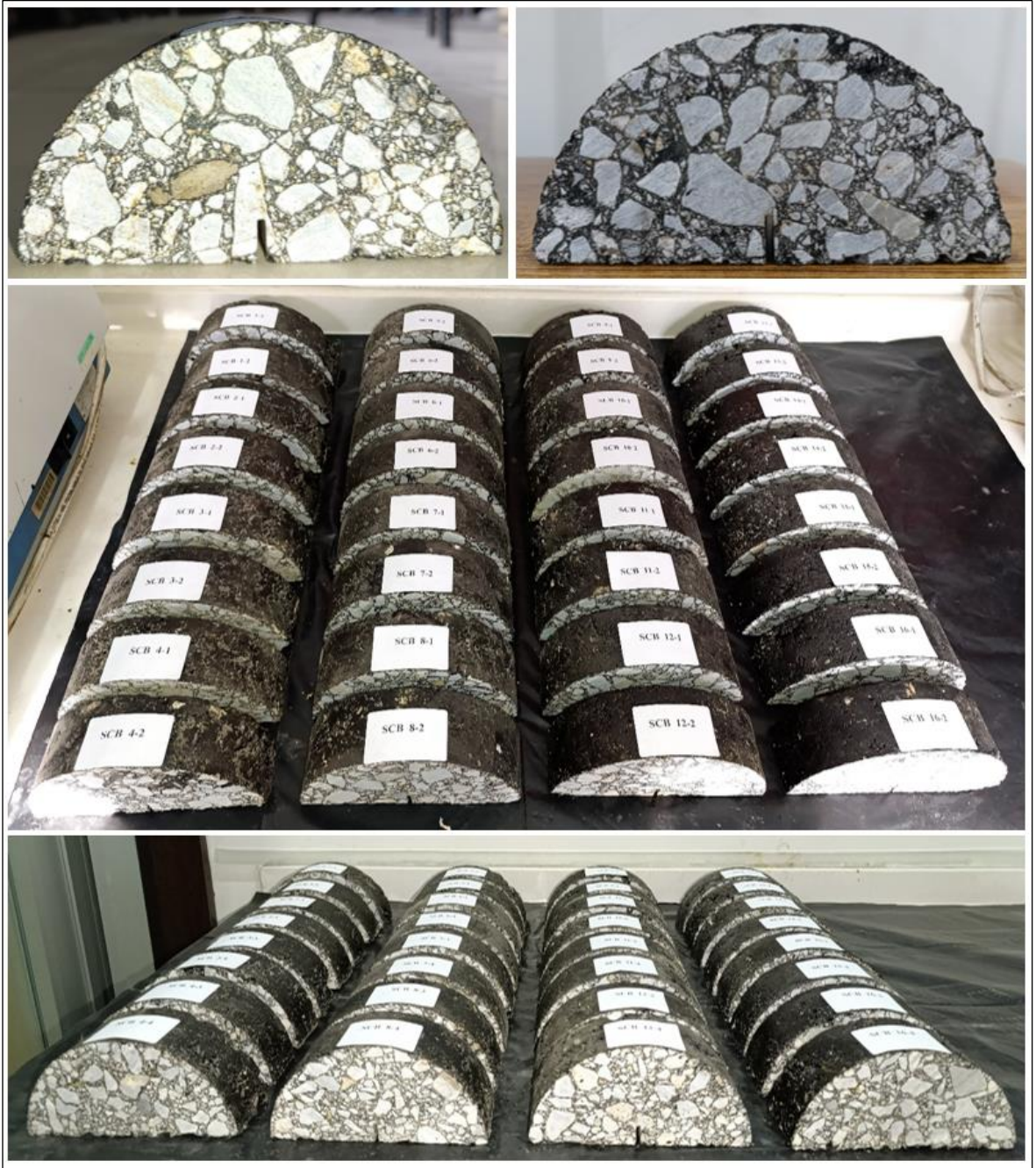
Şekil 29. SCB deney numuneleri
