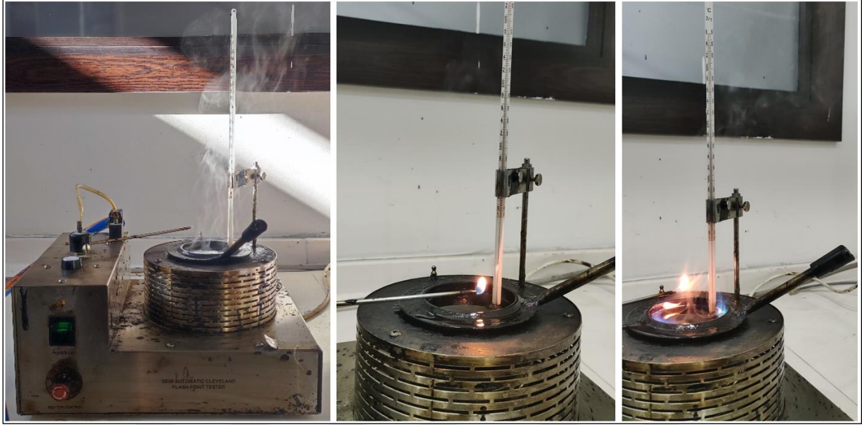
Şekil 18. Parlama noktası deney cihazı
