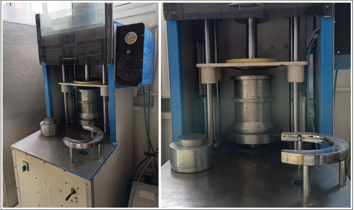
Şekil 26. Yoğurmalı sıkıştırıcı (Gyratory)
