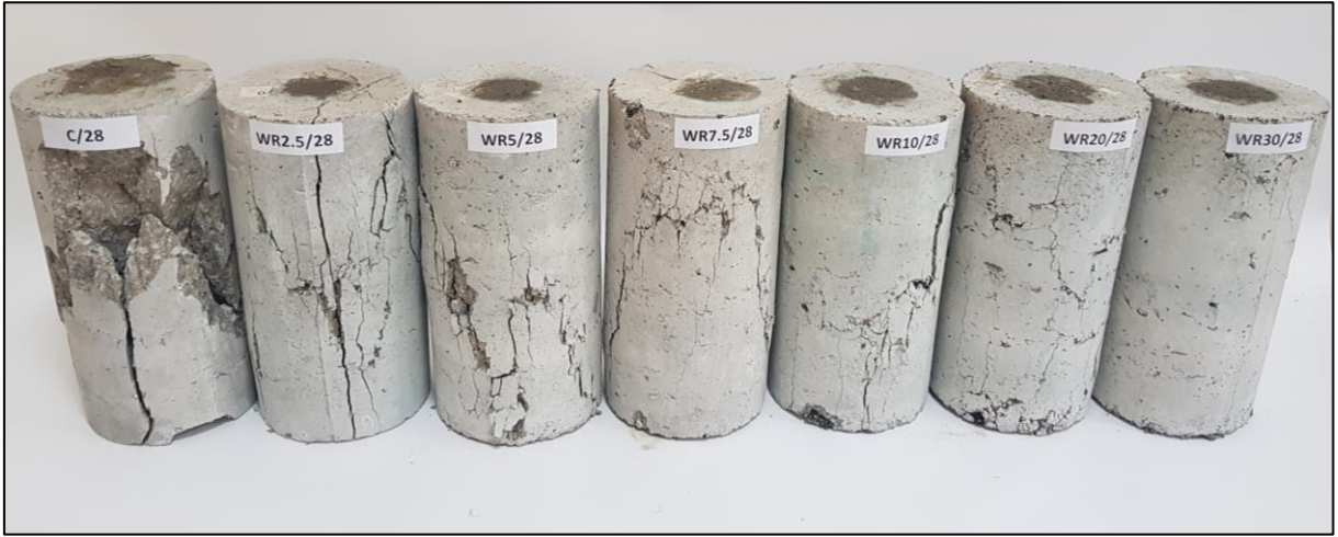
Şekil 61. SSB numunelerinin basınç dayanımı testi sonrası kırılma yüzeyleri.
