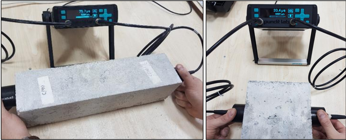
Şekil 41. Ultrases geçiş hızı deneyinin yapılışı.
