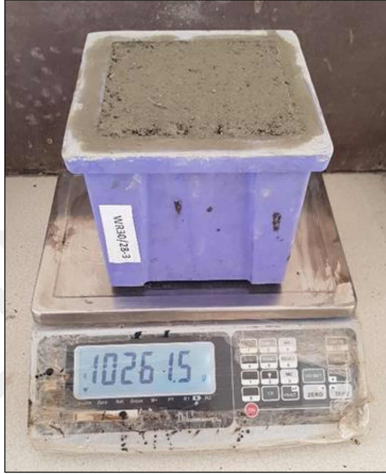
Şekil 35. Taze beton birim ağırlık deneyi.
