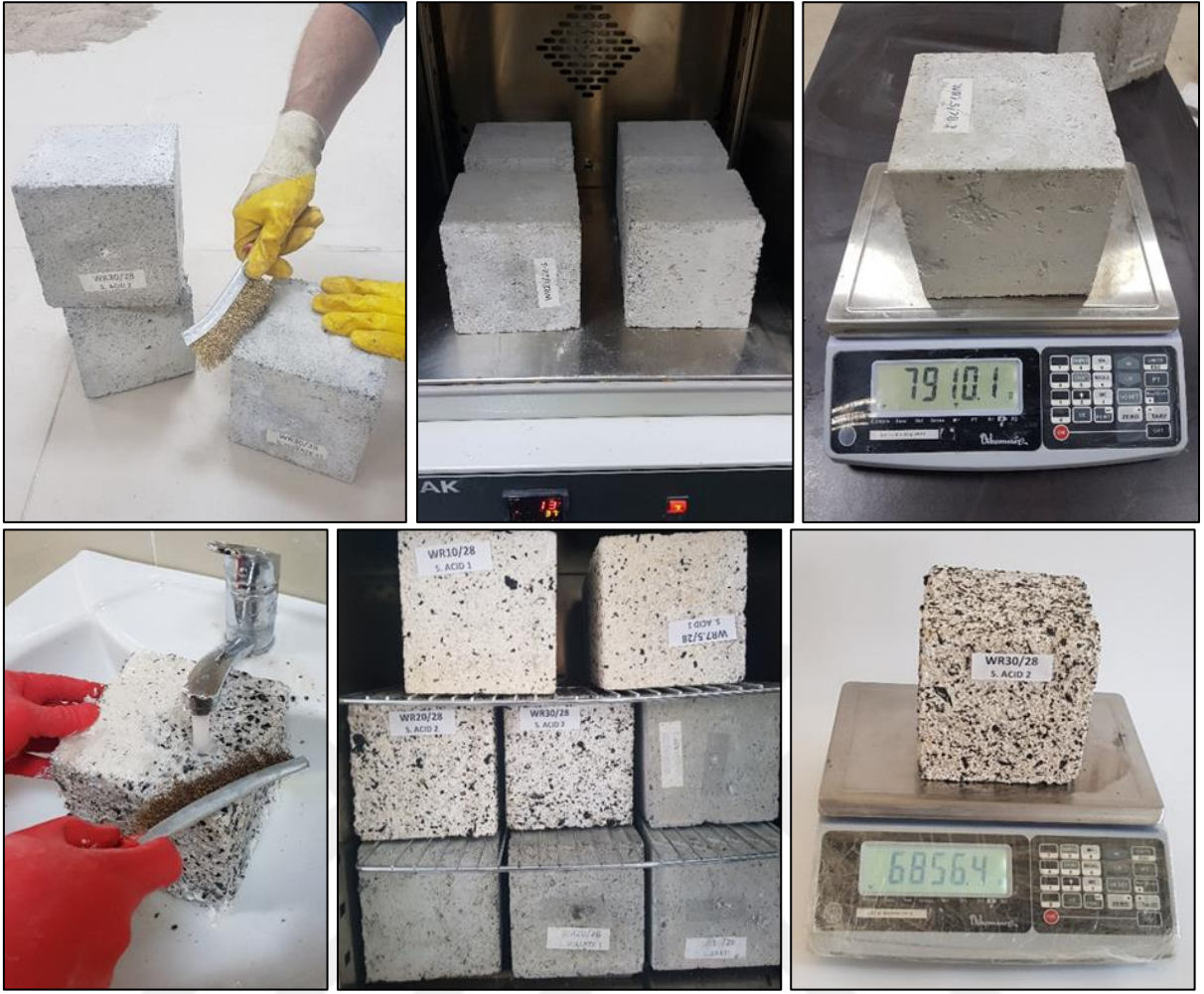
Şekil 51. Numunelerin asit ve sülfat çözeltilerine daldırılmadan önce ve sonra temizlenmesi, etüvde kurutulması ve tartılması.
