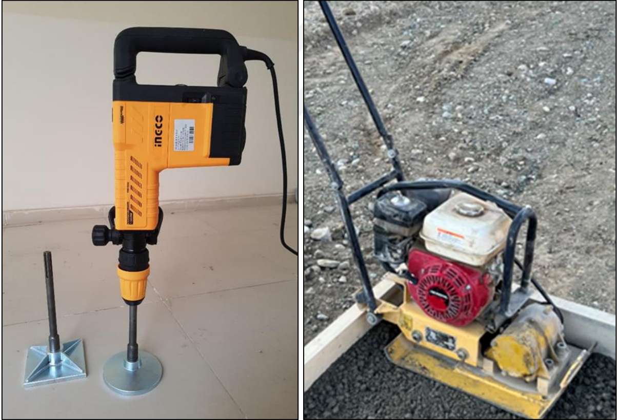
Şekil 31. SSB numunelerin üretilmesinde kullanılan titreşimli tokmak ve el kompaktörü.
