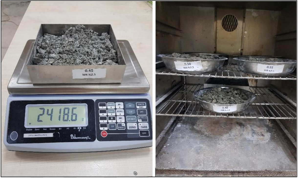
Şekil 29. Numunelerin ağırlıklarının belirlenmesi ve etüvde kurutulması.
