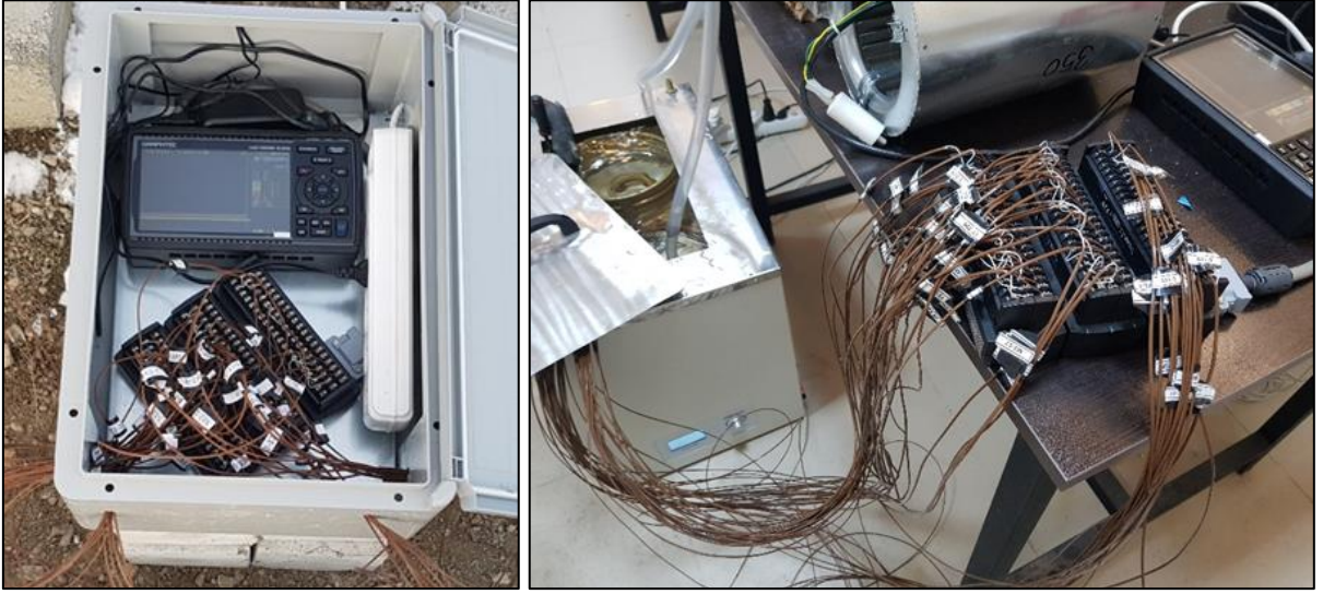
Şekil 55. Sıcaklık veri kaydedicisi ve termokuplların kalibrasyonu.
