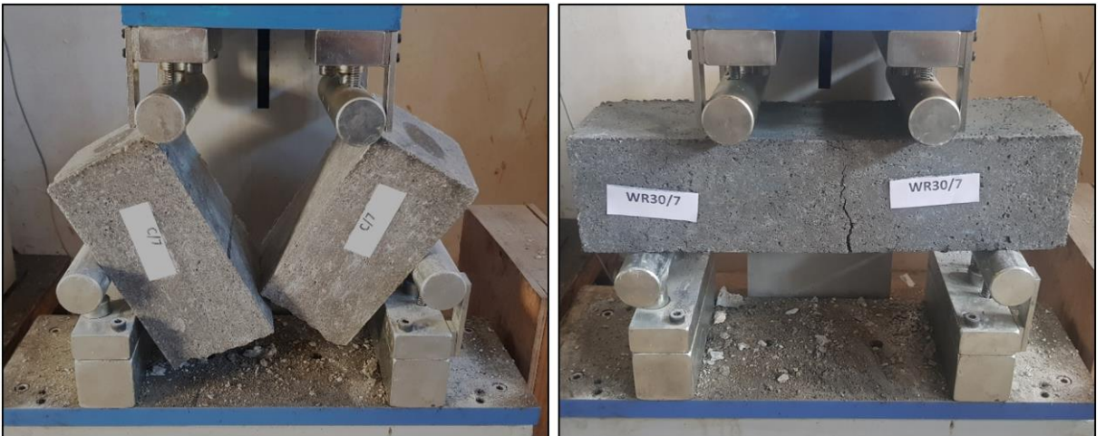
Şekil 67. C ve WR30 SSB numunelerinin eğilme dayanımı testi sonrası kırılma yüzeyleri.
