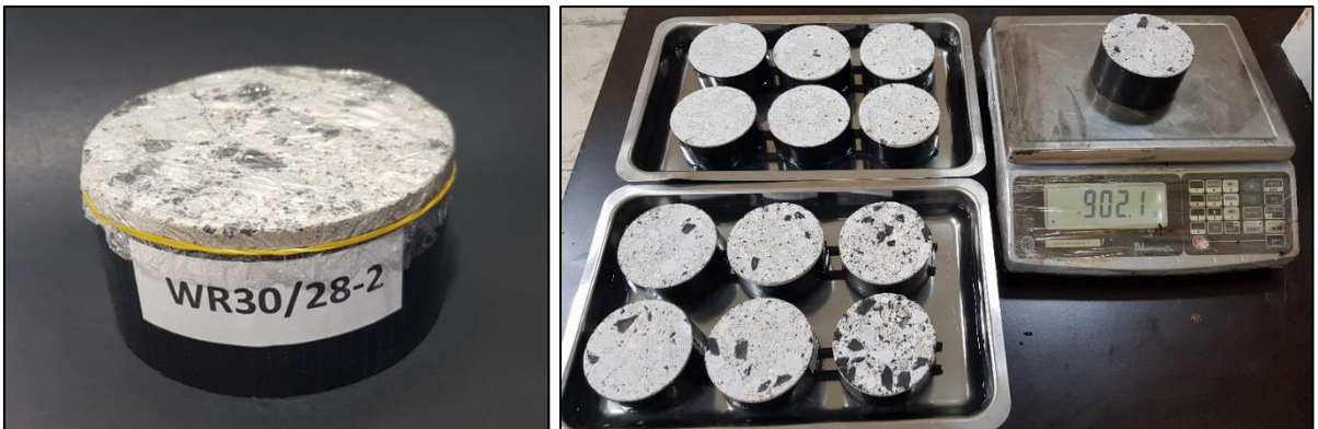
Şekil 44. Kılcal su emme testi için hazırlanan SSB diskler ve testin yapılışı.
