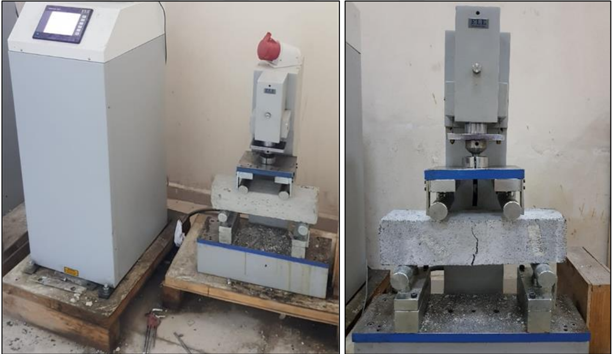
Şekil 39. Eğilme deneyi cihazı ve deneyin yapılışı.
