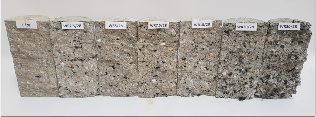
Şekil 65. SSB numunelerinin yarmada çekme dayanımı testi sonrası kırılma yüzeyleri.
