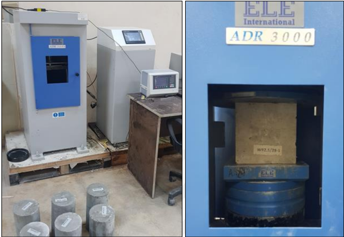
Şekil 36. Tek eksenli basınç deneyi cihazı ve deneyin yapılışı.
