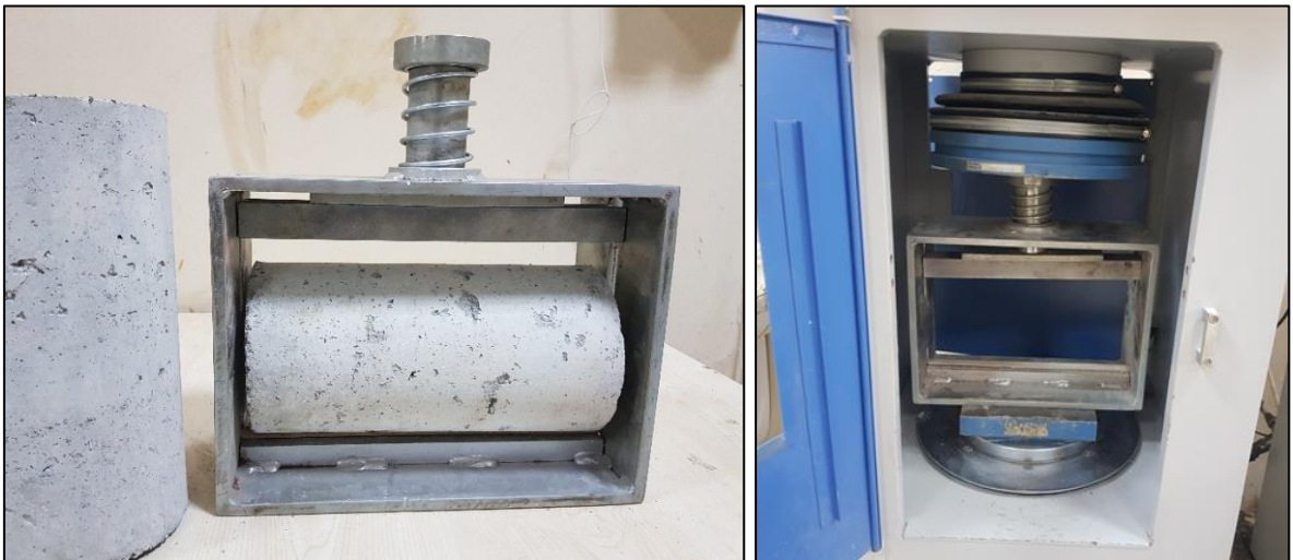
Şekil 38. Yarmada çekme deney düzeneği ve deneyin yapılışı.
