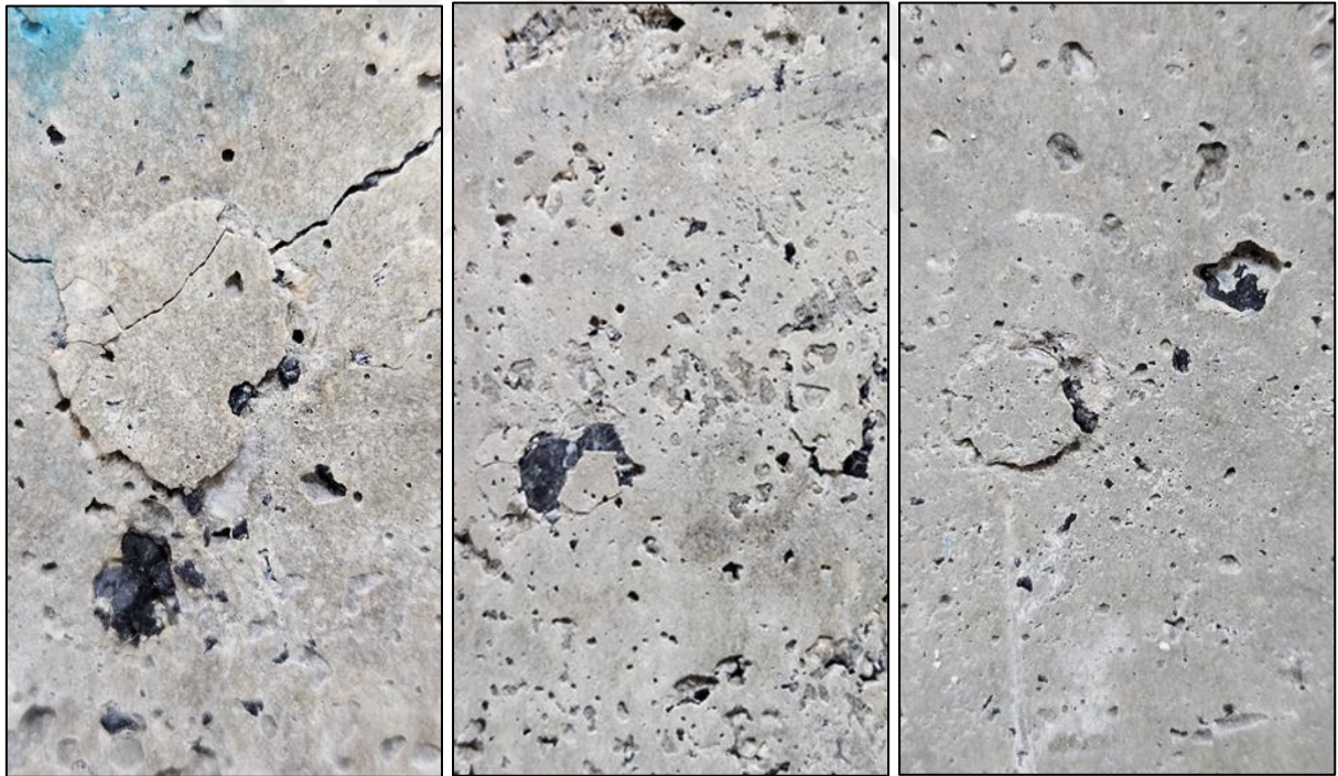
Şekil 96. Donma-çözünme döngülerine maruz kalan SSB numunelerde meydana gelen pullanmalar.
