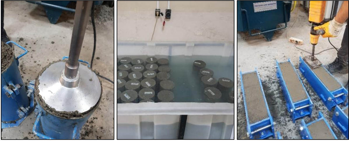
Şekil 32. SSB numunelerin üretimi ve kür.
