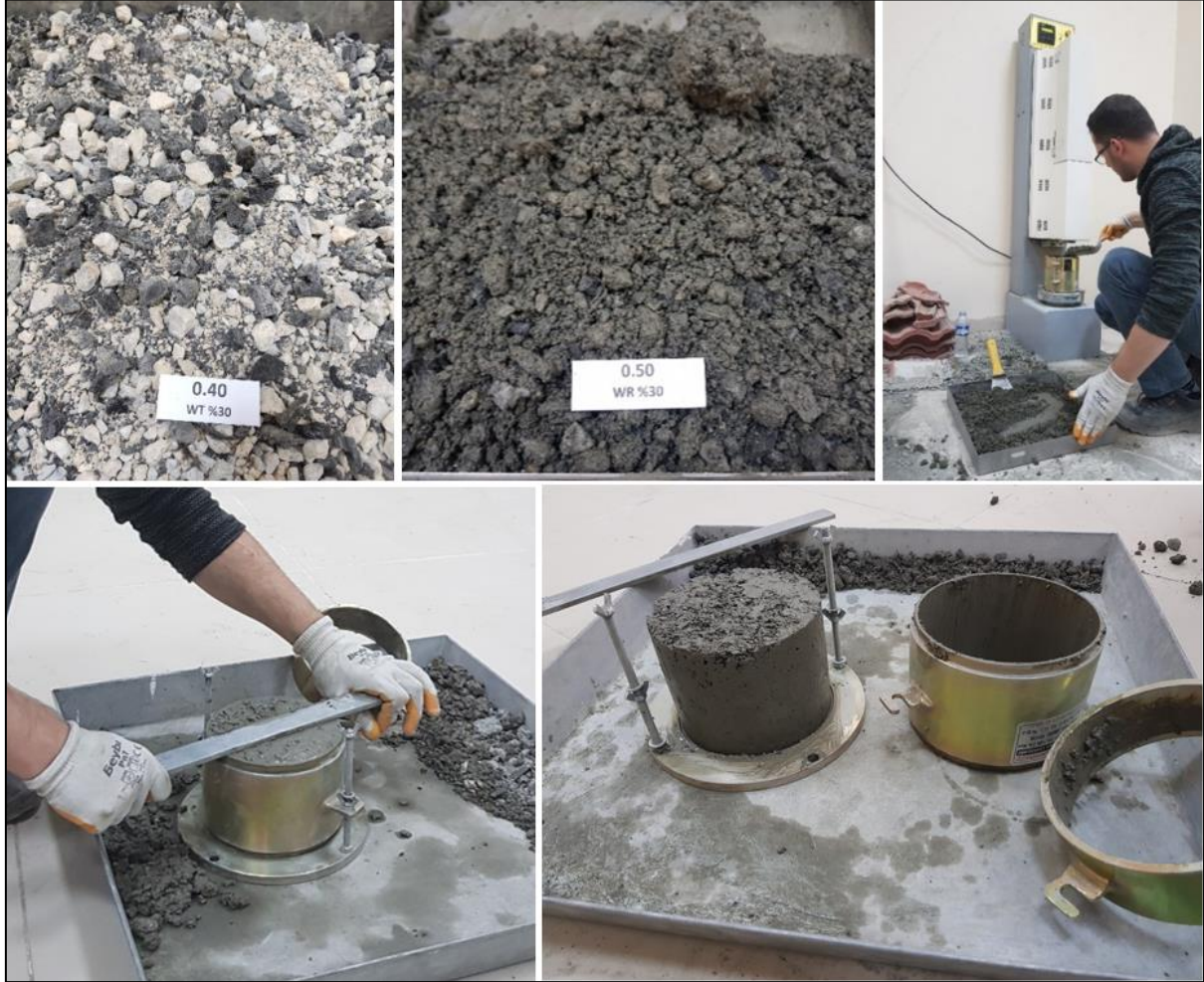
Şekil 28. SSB karışımlar için modifiye proktor deneyinin yapıışı.
