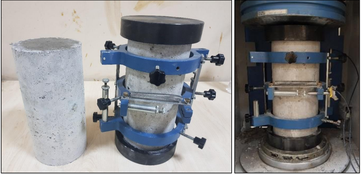
Şekil 37. Elastisite modülü deney düzeneği ve deneyin yapılışı.
