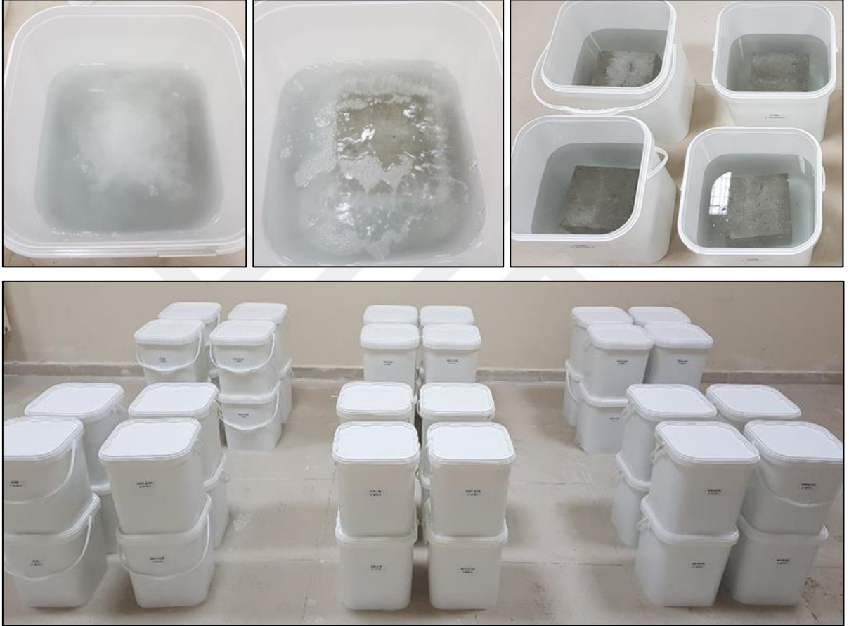
Şekil 49. Numunelerin sülfirik asit ve sodyum sülfat çözeltilerine daldırılması ve kapalı şekilde bekletilmesi.
