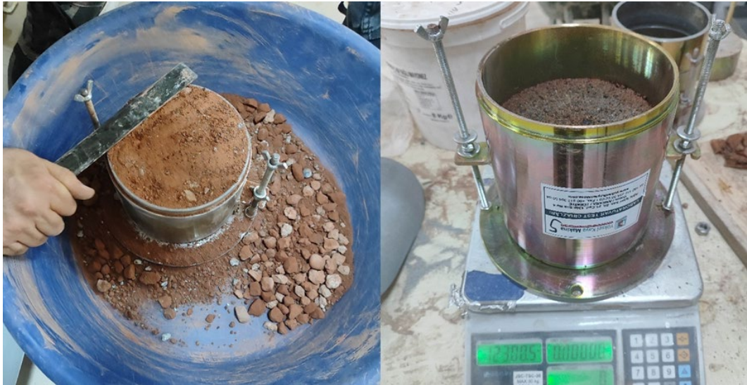
Şekil 16. Numunenin tıraşlanması ve tartılması
