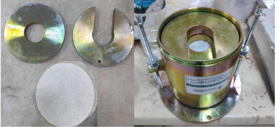
řekil 18. Ara ykleme diski, yarıklı srsaj aęırlığı, filtre kaęıdının kalıba yerleřtirilmesi
