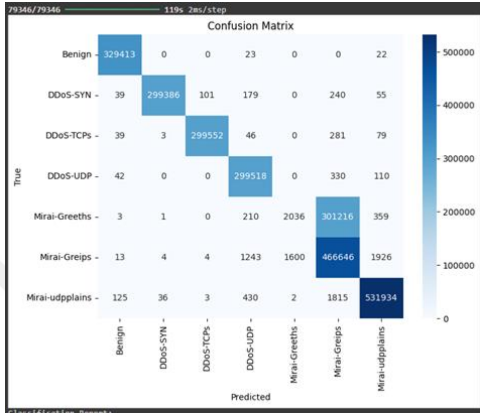
Şekil 5.6. CNN-LSTM + attention modeline ait confusion matrix (özellikle mirai sınıflarında ayırım gücünde düşüş gözlenmiştir).
