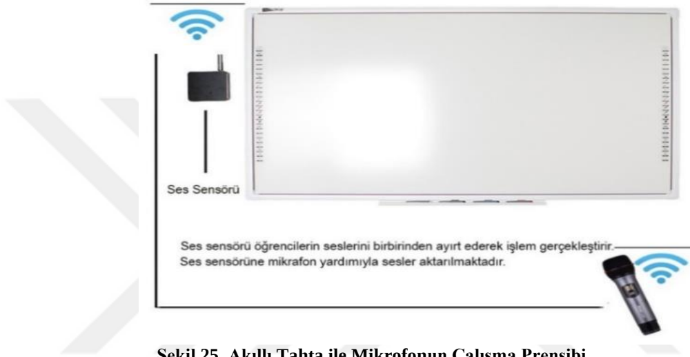
Şekil 25. Akıllı Tahta ile Mikrofonun Çalışma Prensibi
