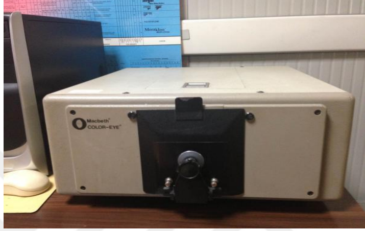
Şekil 3.6. Macbeth Color - Eye MS2020 spektrofotometre
