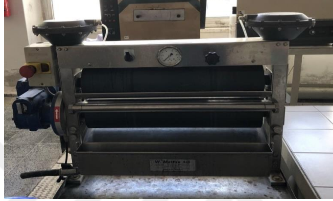
Şekil 3.2. Laboratuvar Tipi Numune Emdirme Makinesi
