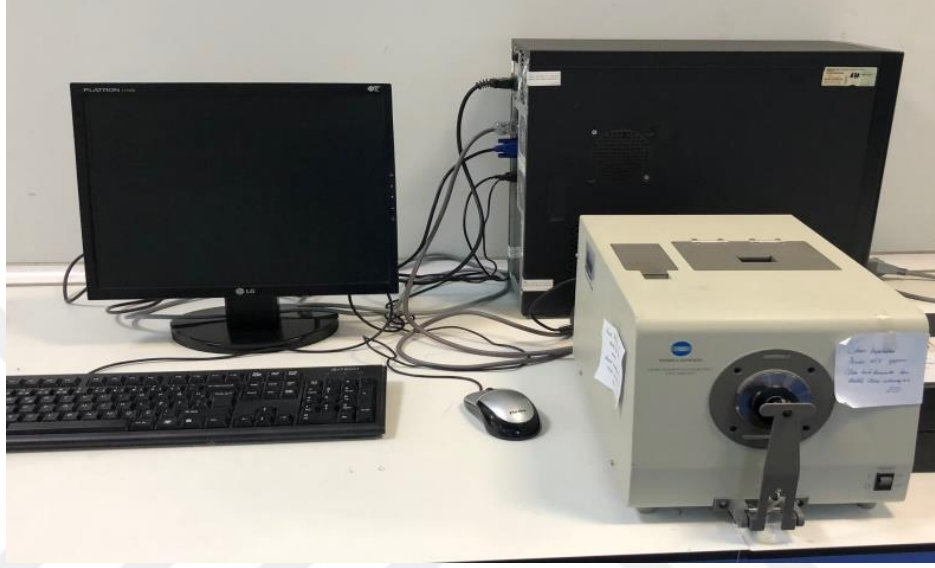
Şekil 3.8. Konica Minolta 3600d Spektrofotometresi
