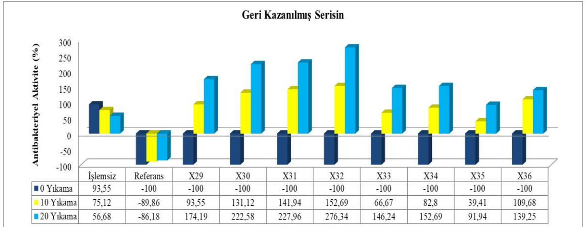
Şekil 4.15. Geri kazanılmış serisin uygulanmış kumaşların E. coli bakterisine karşı antibakteriyel aktivite değerleri
