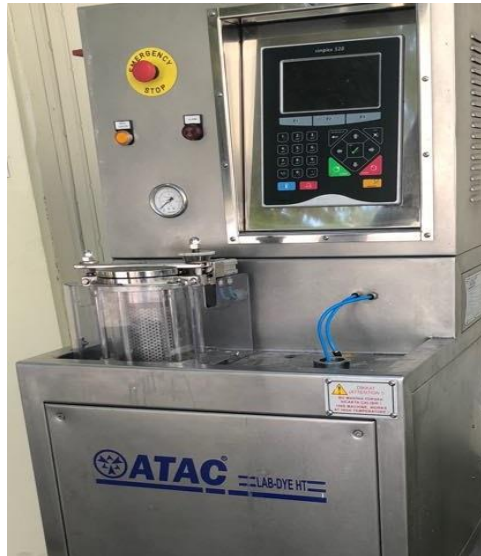
Şekil 3.1. Numune bobin boyama makinesi
