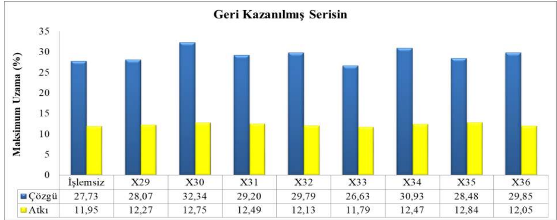
Şekil 4.35. Ham pamuk ve geri kazanılmış serisin uygulanmış pamuklu kumaşların atkı ve çözgü yönündeki % uzama değerleri
