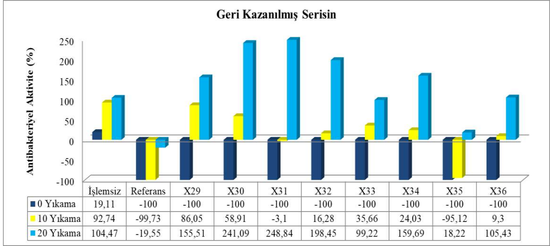
Şekil 4.10. Geri kazanılmış serisin uygulanmış kumaşların S. aureus bakterisine karşı antibakteriyel aktivite değerleri
