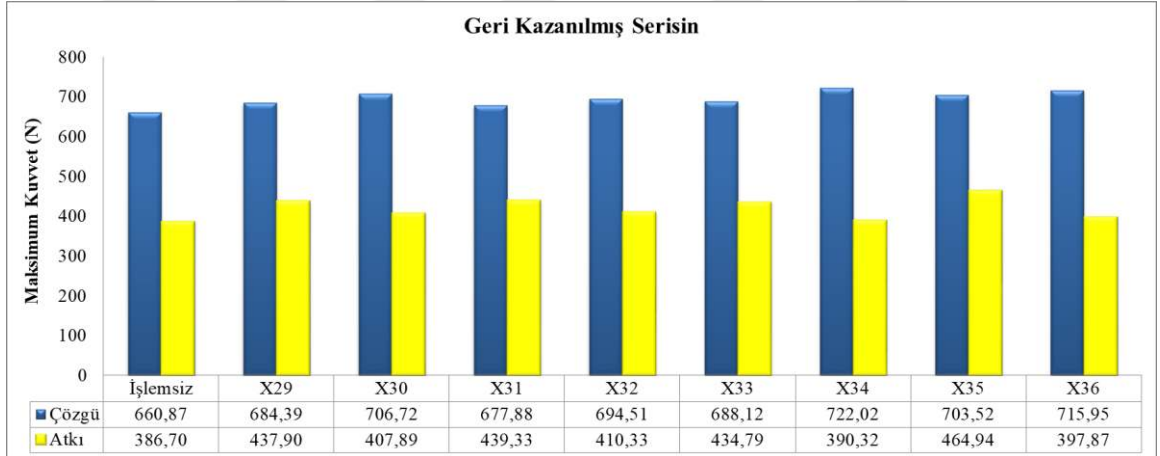
Şekil 4.34. Ham pamuk ve geri kazanılmış serisin uygulanmış pamuklu kumaşların atkı ve çözgü yönündeki kopma mukavemeti değerleri
