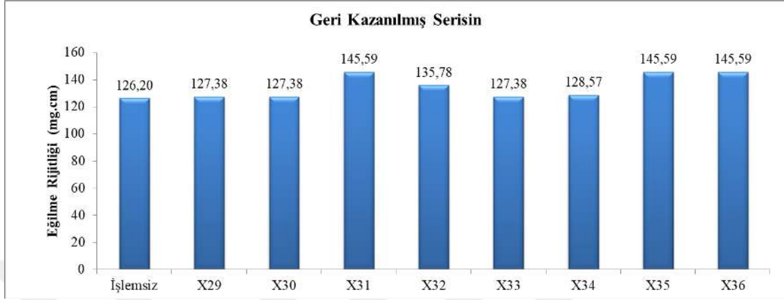
Şekil 4.40. Geri kazanılmış serisin uygulanmış kumaşların eğilme rijitliği değerleri
