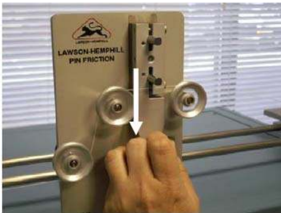
Şekil 2.7 İplik-materyal sürtünmesi testi öncesinde ipliğin konumu (CTT İplik Sürtünmesi Test Cihazı Kullanım Kılavuzu)
