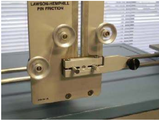
Şekil 2.8 İplik-materyal sürtünmesi sırasında ipliğin konumu (CTT İplik Sürtünmesi Test Cihazı Kullanım Kılavuzu)
