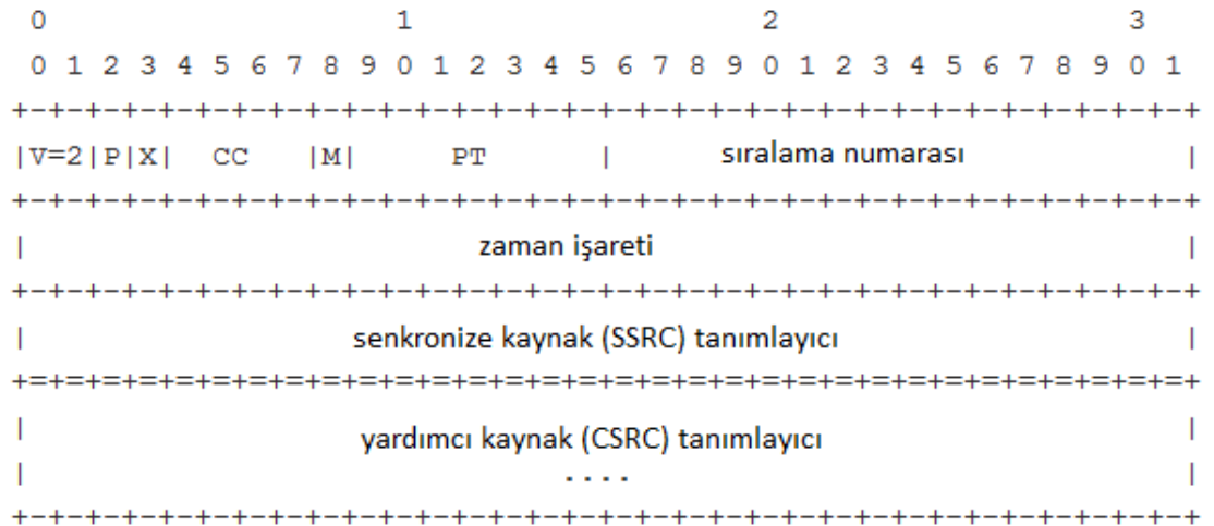
Şekil 2.13. RTP başlık yapısında sabit alanlar [16]
