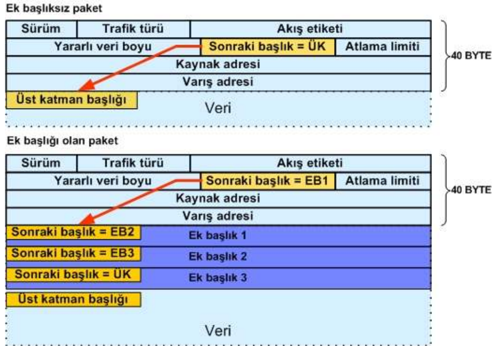
Şekil 2. IPv6 ek başlığının kullanımı
