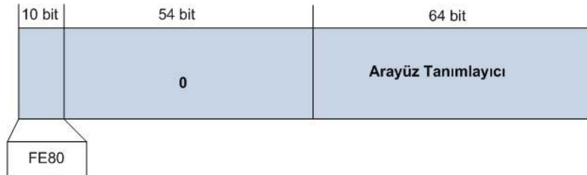
Şekil 12. IPv6 link-local adres yapısı
