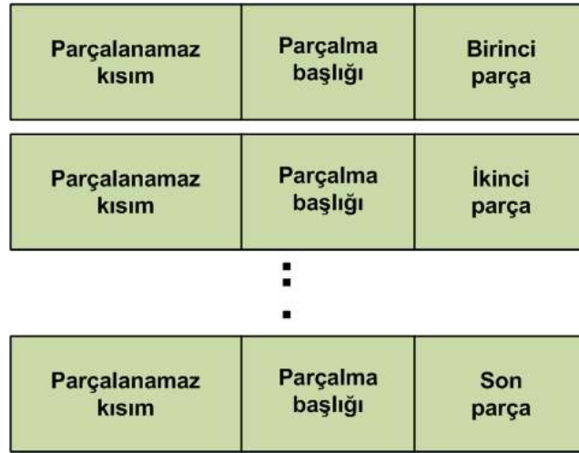
Şekil 7. IPv6 parçalama işlemi
