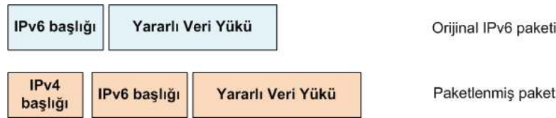
Şekil 16. IPv4 içine IPv6 paketleme
