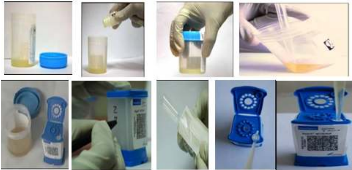
Şekil 2.3. Numuneyi kartuşa yerleştirme adımları.
