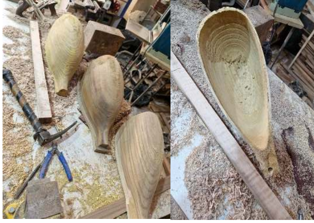
Şekil 2.2 Tek parça (oyma formda) tanbûr çanağı (Tanbur Mehrdrad Tanbûr atölyesinden görüntülendi).
