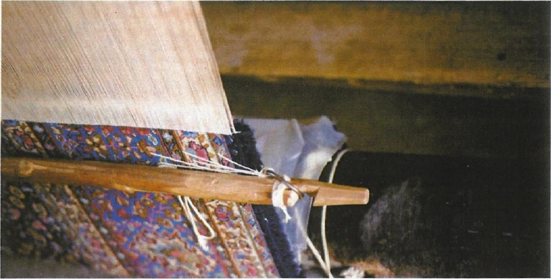
Şekil 105: Bu Aleti Halının Eğri Dokunmasını Önlemek İçin Kullanıyorlar
