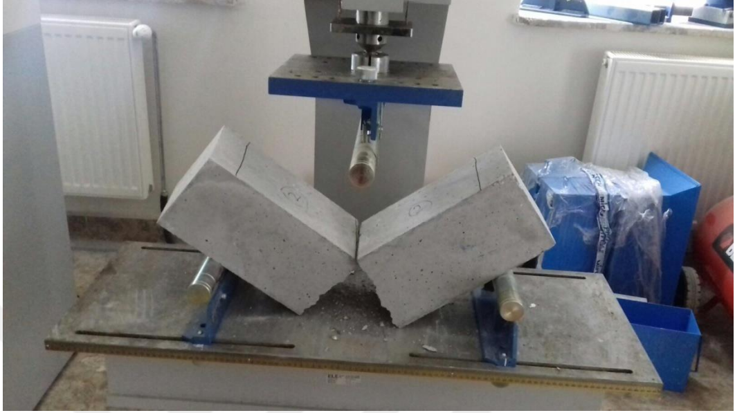
Resim 4.14 Kiriş numunelerde eğilme deneyi (yükleme sonrası)
