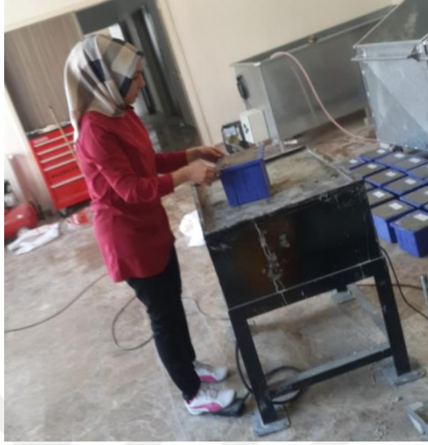
Resim 4.8 Beton numunelerinin vibrasyon masasında sıkıştırılması
