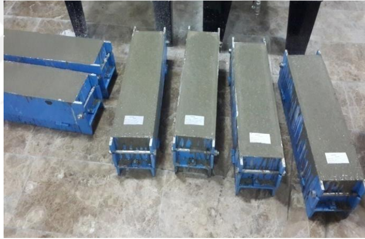
Resim 4.10 Çalışmalar sonucunda kiriş numuneler yardımıyla üretilen betonlar
