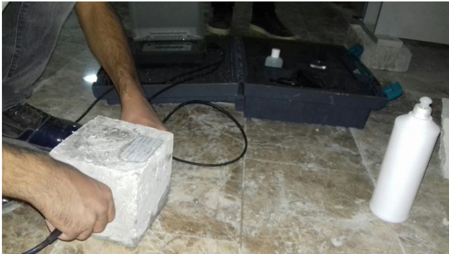
Resim 4.12 Küp numunelerde ultrases deneyi
