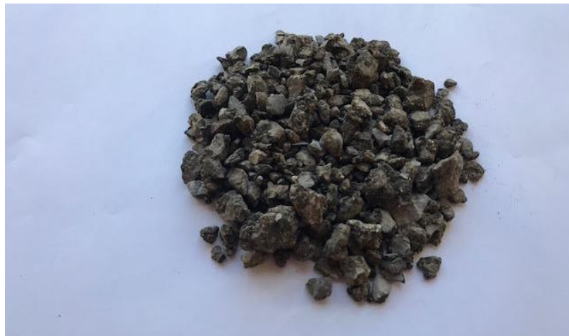
Resim 4.4 Beton karışımlarında kullanılan kazınmış asfalt malzeme
