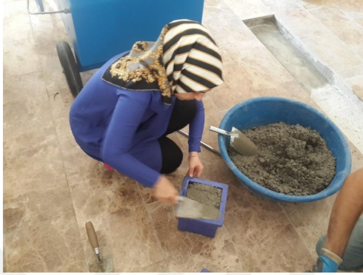
Resim 4.7 Beton numunelerinin kalıplara doldurulması
