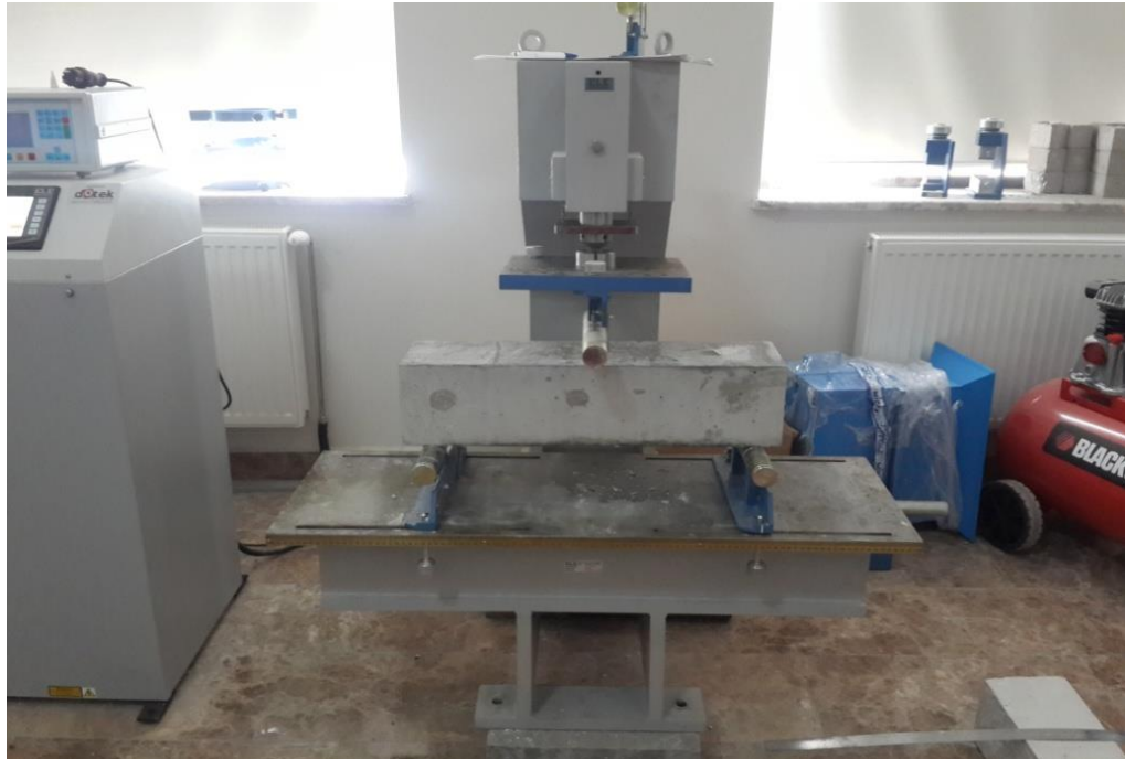
Resim 4.13 Kiriş numunelerde eğilme deneyi (yükleme öncesi)
