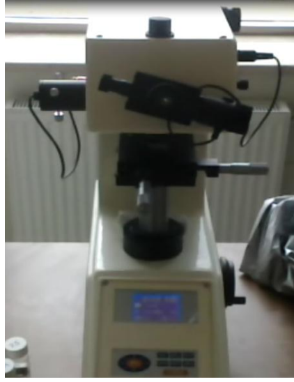
Resim 3.7 Mikro Sertliklerini Öldüğümüz Mikroskobumuz.
