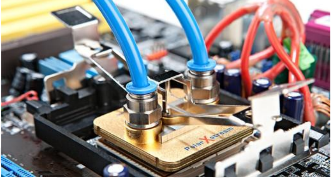
Şekil 6. Mikrokanallı Isı Alıcısı Tabanlı Elektronik Soğutma Uygulama Örneği (Anonymous, 2020a)
