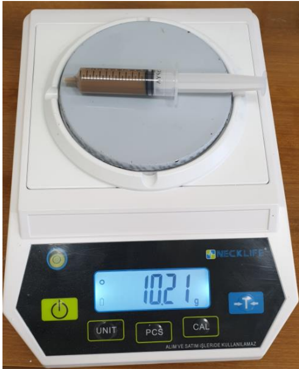
Şekil 6.8. Nano akışkanların yoğunluk ölçümü
