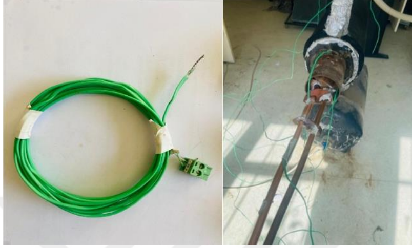
Şekil 6.3. T tipi nikel-krom termokupl ve deney seti üzerindeki bağlantıları
