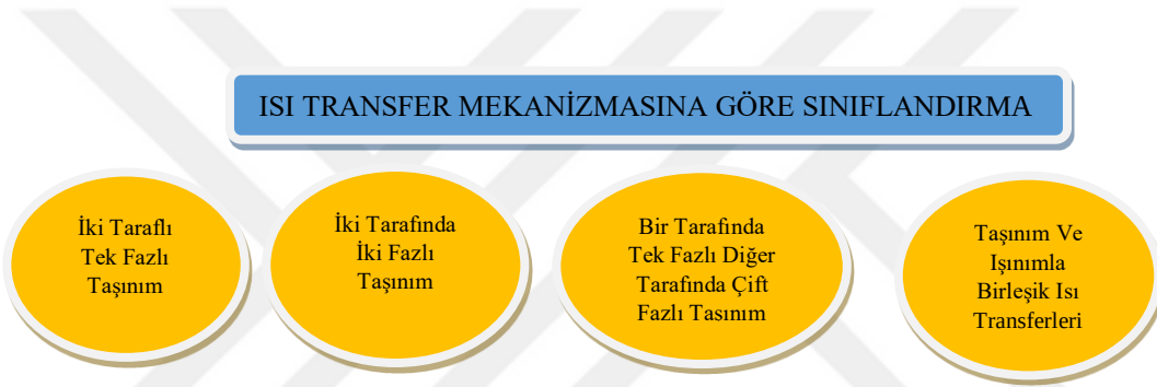
Şekil 5.4. Isı transfer mekanizmasına göre ısı eşanjörlerinin sınıflandırılması
