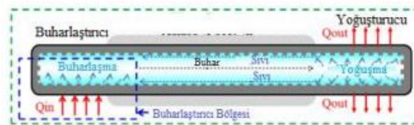
Şekil 4.3. Düz plakalı ısı borusunun şematik resmi (Chen, 2017)
