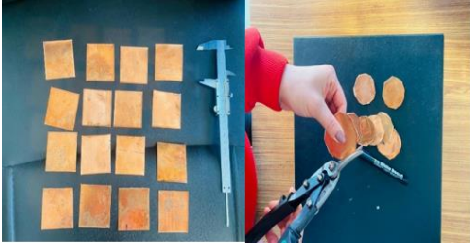
Şekil 6.9. Saf bakır levhaların kesilmesi
