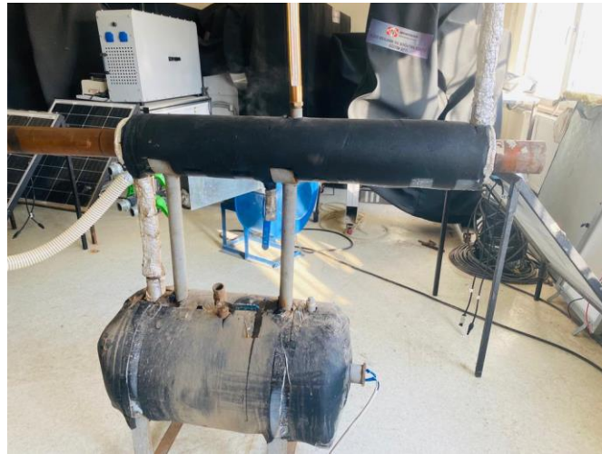
Şekil 6.8. Isı eşanjörü ve kazan
