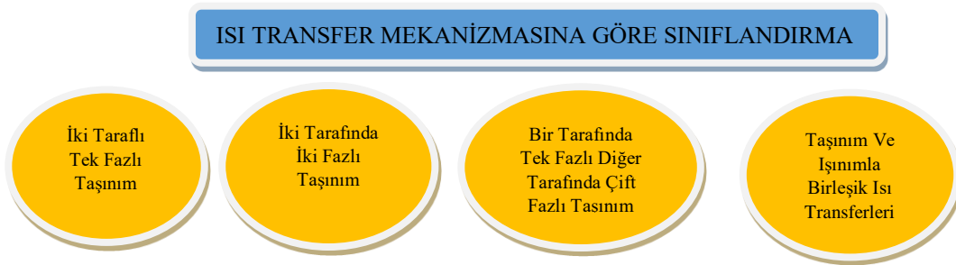
Şekil 5.4. Isı transfer mekanizmasına göre ısı eşanjörlerinin sınıflandırılması
