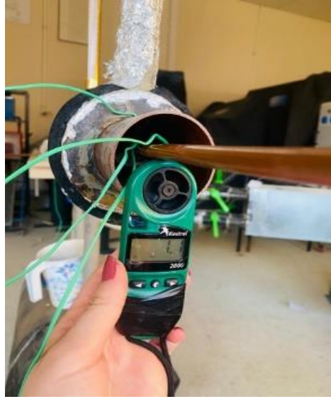
Şekil 6.6. Kestrel 2000 dijital anemometre
