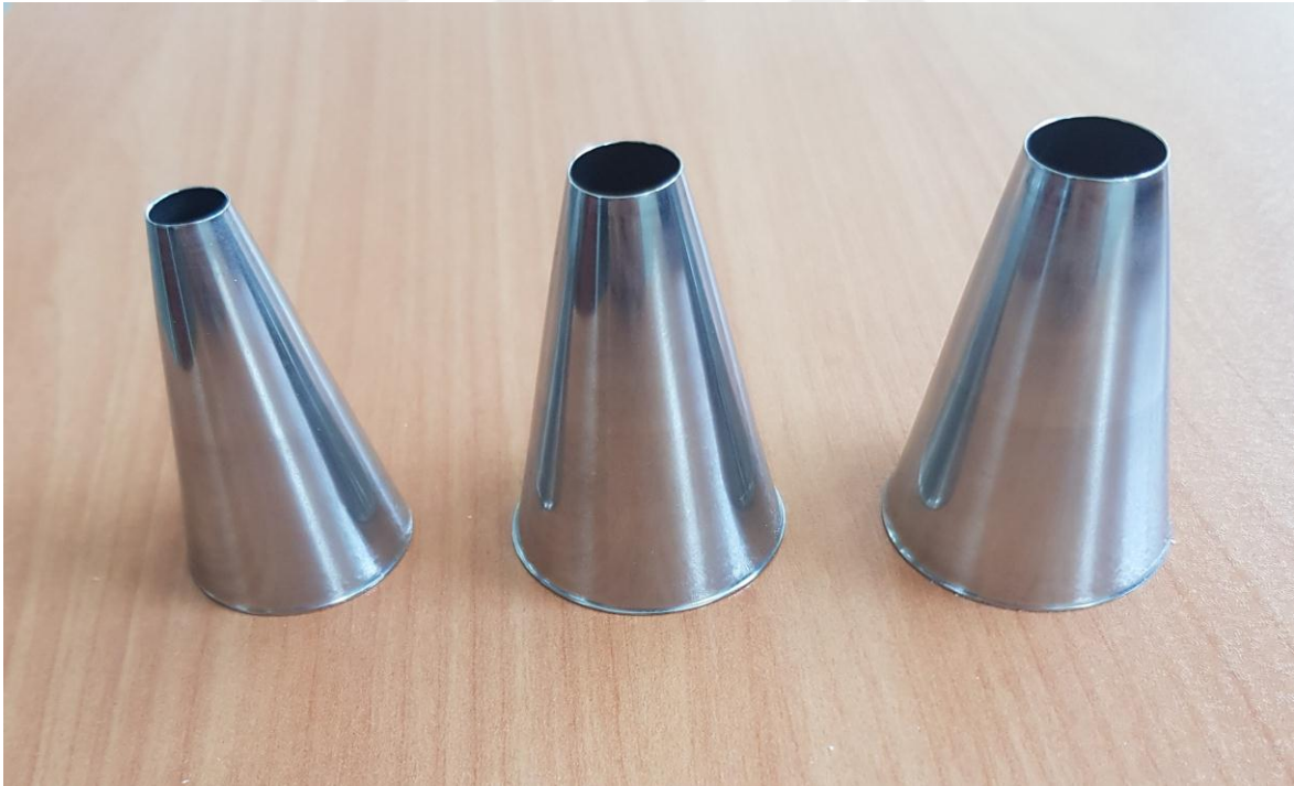
Şekil 2.2 t1 şeklindeki konik türbülatorler
