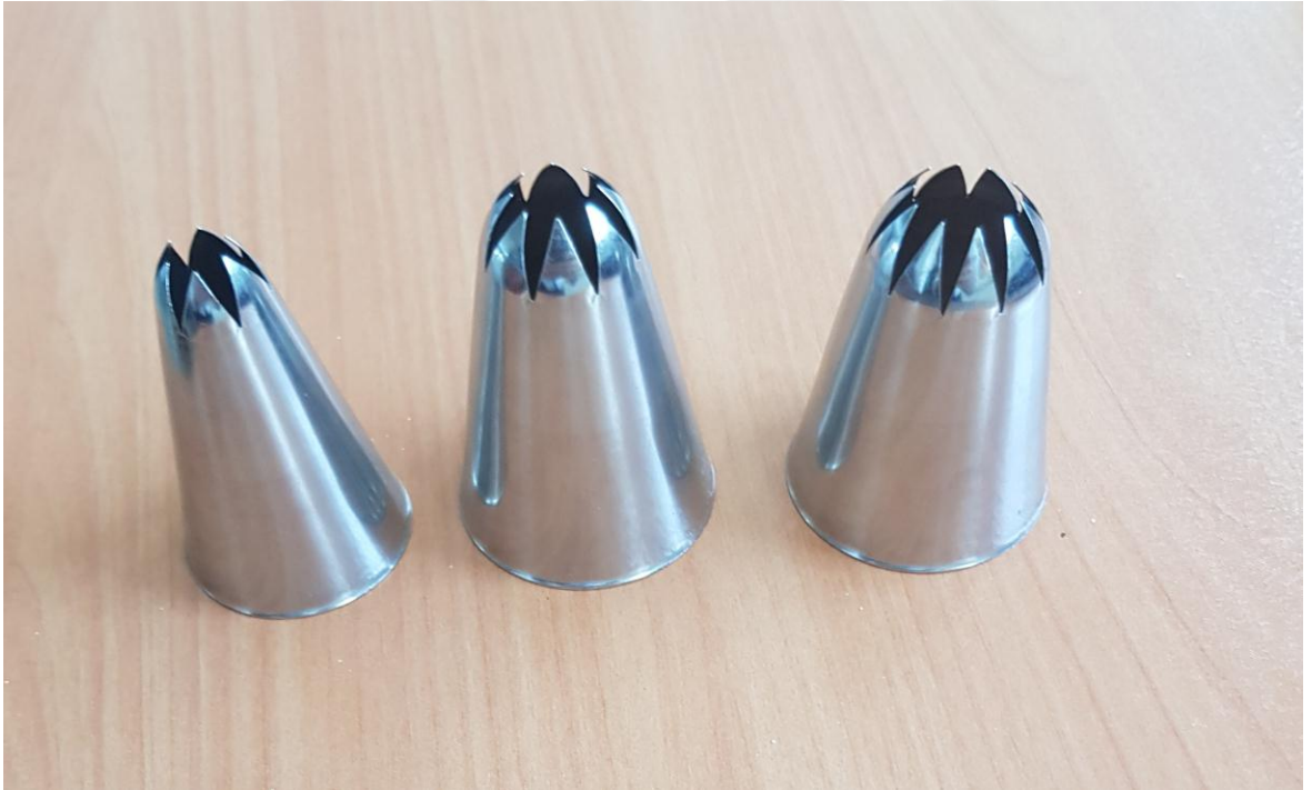
Şekil 2.4 t3 şeklindeki konik türbülatorler
