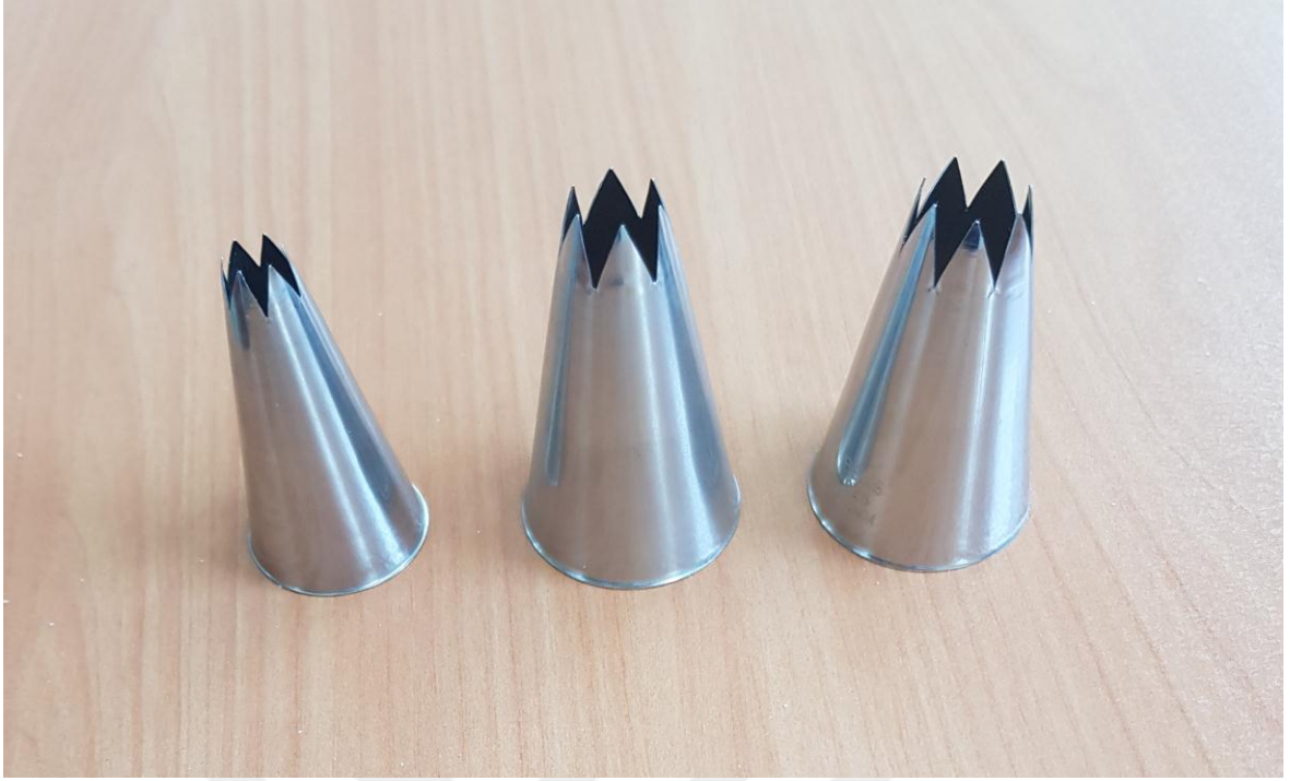
Şekil 2.3 t2 şeklindeki konik türbülatorler
