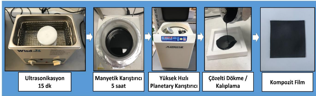
Şekil 3.1. SEBS/PCL/GNP polimer kompozit filmlerin hazırlanması
