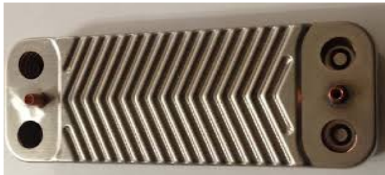
Şekil 4.9: Deney setinde kullanılan plakalı ısı değiştirici.
