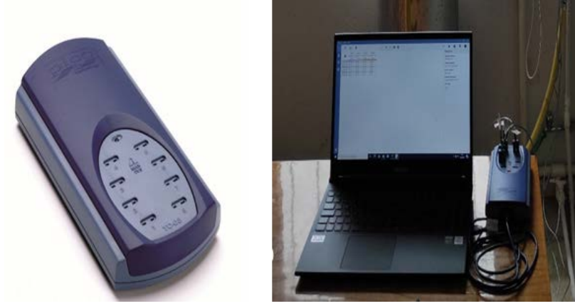
Şekil 4.11: Deney setinde kullanılan veri aktarım cihazı.
