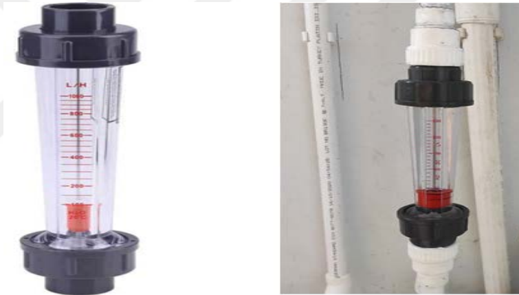
Şekil 4.6: Deney setinde kullanılan debimetre.
