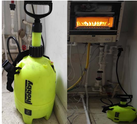
Şekil 4.12: Deney setinde kullanılan mekanik pompa.
