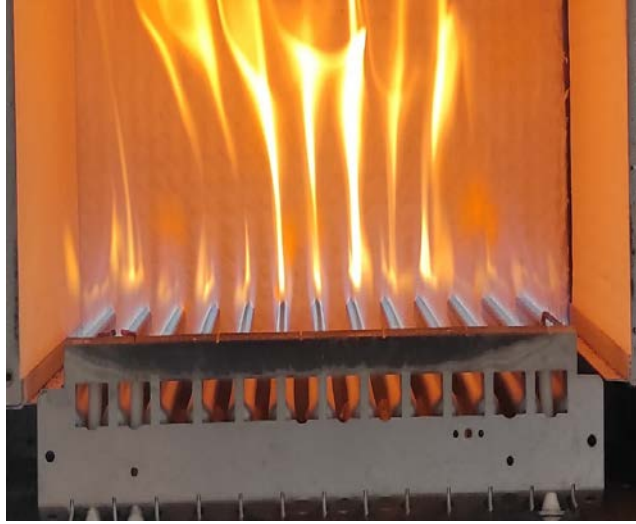
Şekil 4.8: Deney setinde kullanılan atmosferik brülör.
