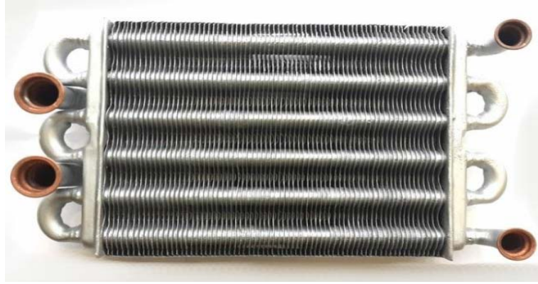
Şekil 4.10: Deney setinde kullanılan ana eşanjör.
