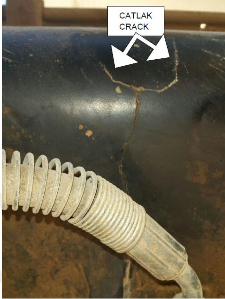
Şekil 3.9. Hidromek 140W iş makinesinin alt şase çatlak görünümü
