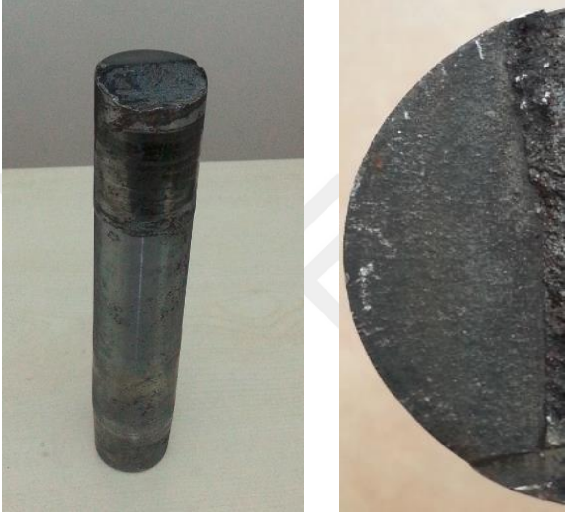
Şekil 3.1. Hasar Gören Perno ve Çatlak başlangıcı ve ilerleme yönü
