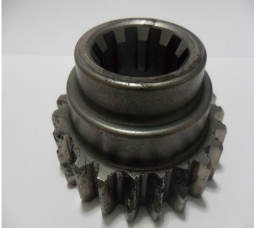
Şekil 3.5. Hasar görmüş dişli parçası
