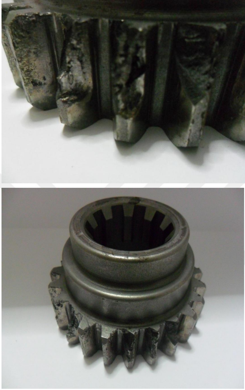
Şekil 3.6. Hasar görmüş dişli parçası ve kırık dişliler
