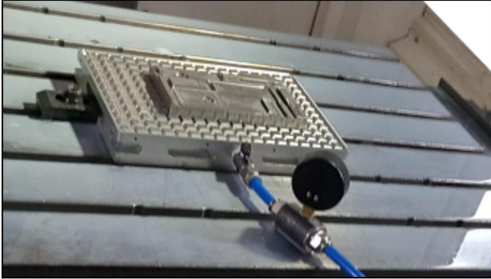
Şekil 4.25 Test için tezgâh tablasına bağlanmış vakum mengene
