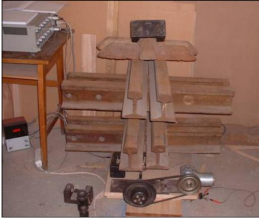
Şekil 3.18 Ağırlık uygulanarak yapılan çekme testi (Csanady vd., 2007)
