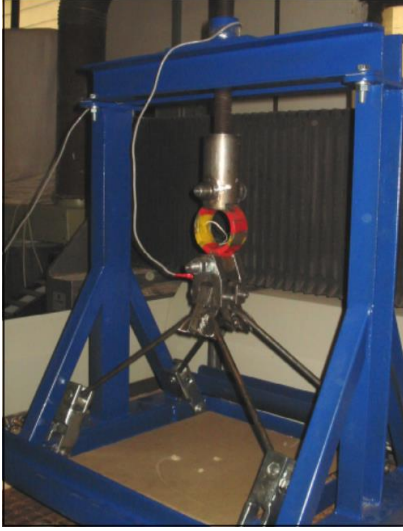
Şekil 3.19 İş parçasının dikey çekilmesi testi (Csanady vd., 2007)
