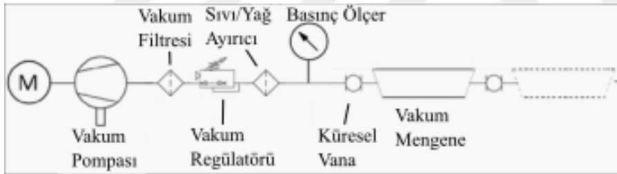
Şekil 4.1 Vakum pompasının kullanıldığı vakum mengene sistemi
