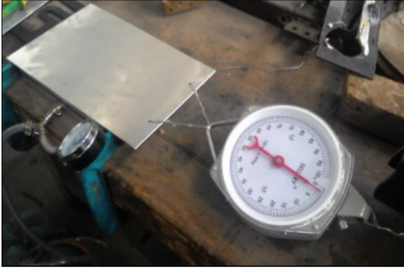
Şekil 3.8 Vakum tabla tutma kuvveti ölçüm testi (Yanel vd., 2019)
