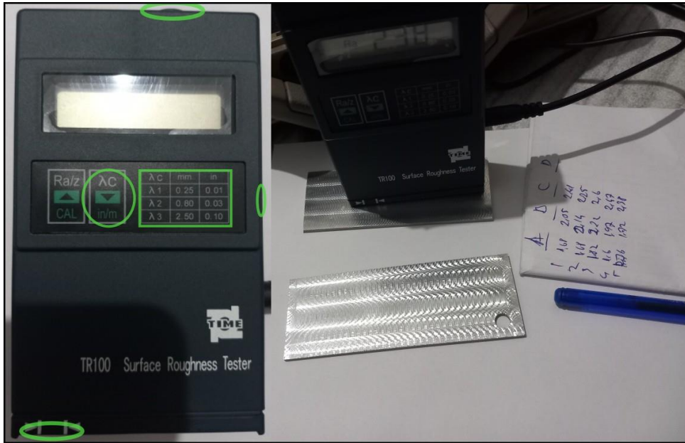
Şekil 4.28 Yüzey pürüzlülük cihazı ve pürüzlülük ölçümlerinin yapılması
