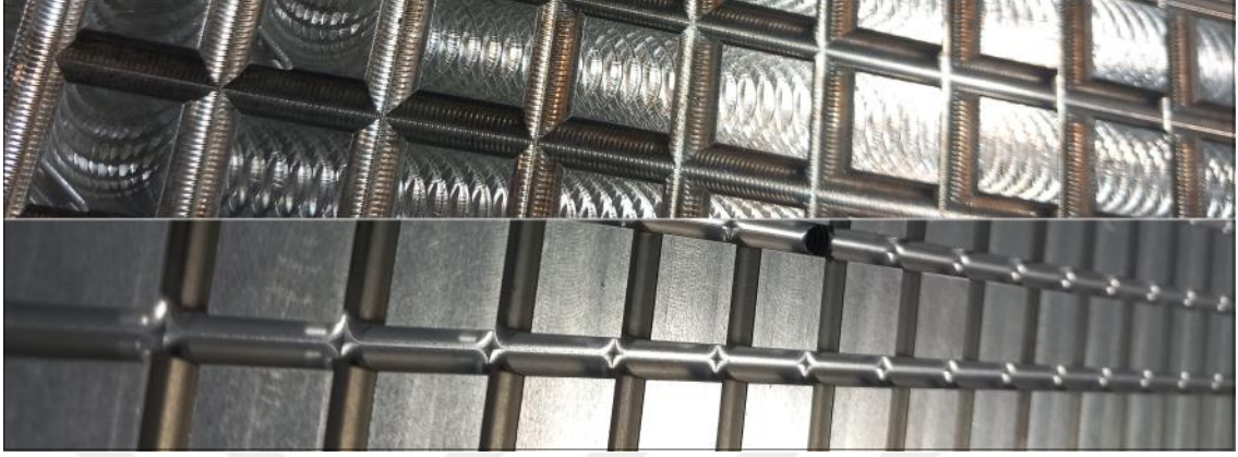
Şekil 5.5 Pürüzleştirme öncesi ve sonrası mengene yüzeyleri arasındaki fark
