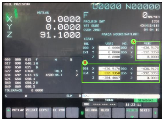
Şekil 4.26 CNC freze tezgâhı kontrol paneli ekranındaki “asıl pozisyon” sekmesi
