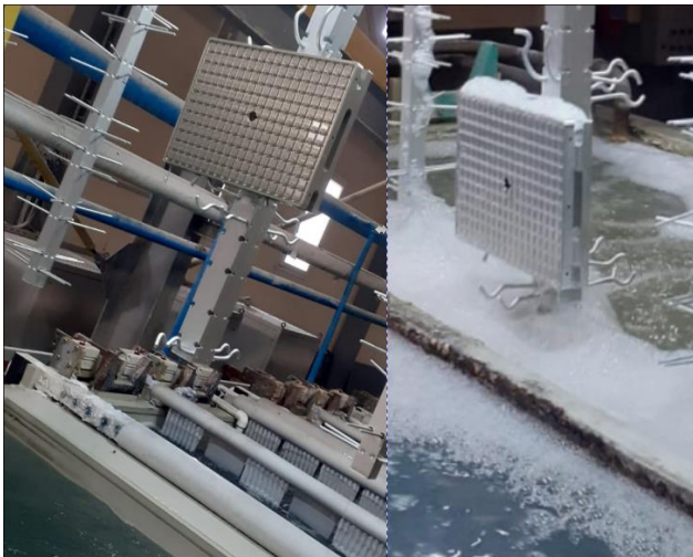
Şekil 4.18 Vakum mengenenin eloksal kaplama işlemine tabi tutulması
