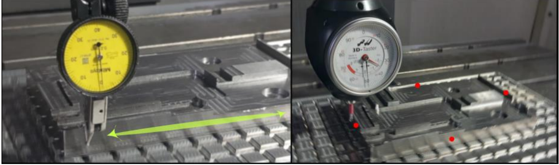
Şekil 4.24 İş parçasının test için komparatör ve sıfırlanma ayarının yapılması
