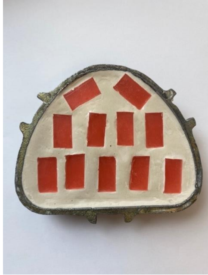
Şekil 3.4. Mum örneklerin muflaya alınması ve elde edilen negatif boşluklar
