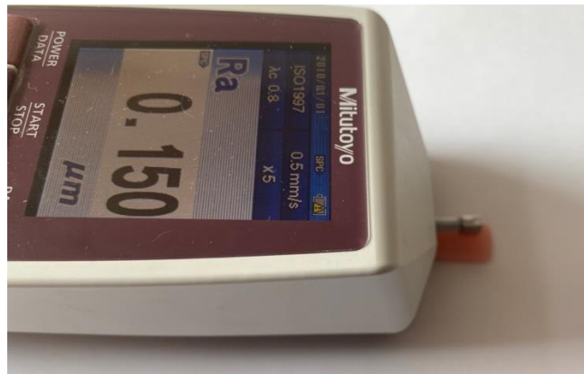
Şekil 3.8. Örneklerin profilometre ile pürüzlülük ölçümleri
