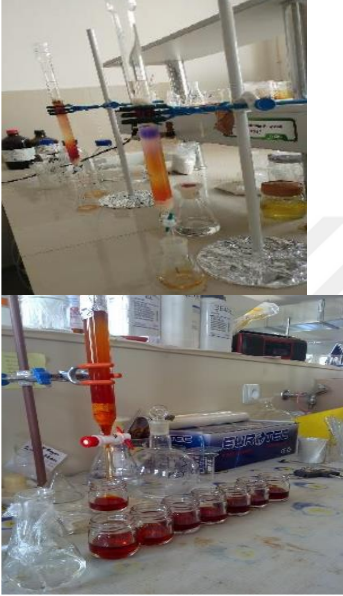
Resim 4.8. Kolon kromatografisi ile saflaştırma yöntemi (Yavuz, 2020).
