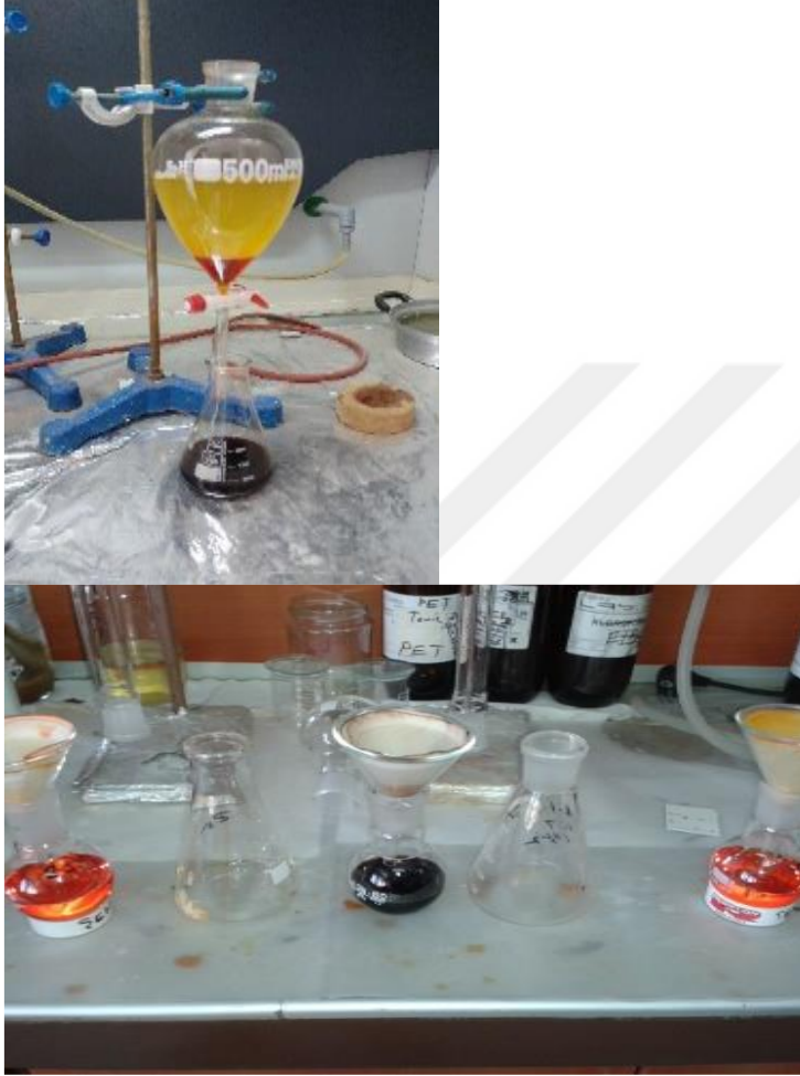
Resim 4.6. Ekstraksiyon ve süzme işlemi (Yavuz, 2020).
