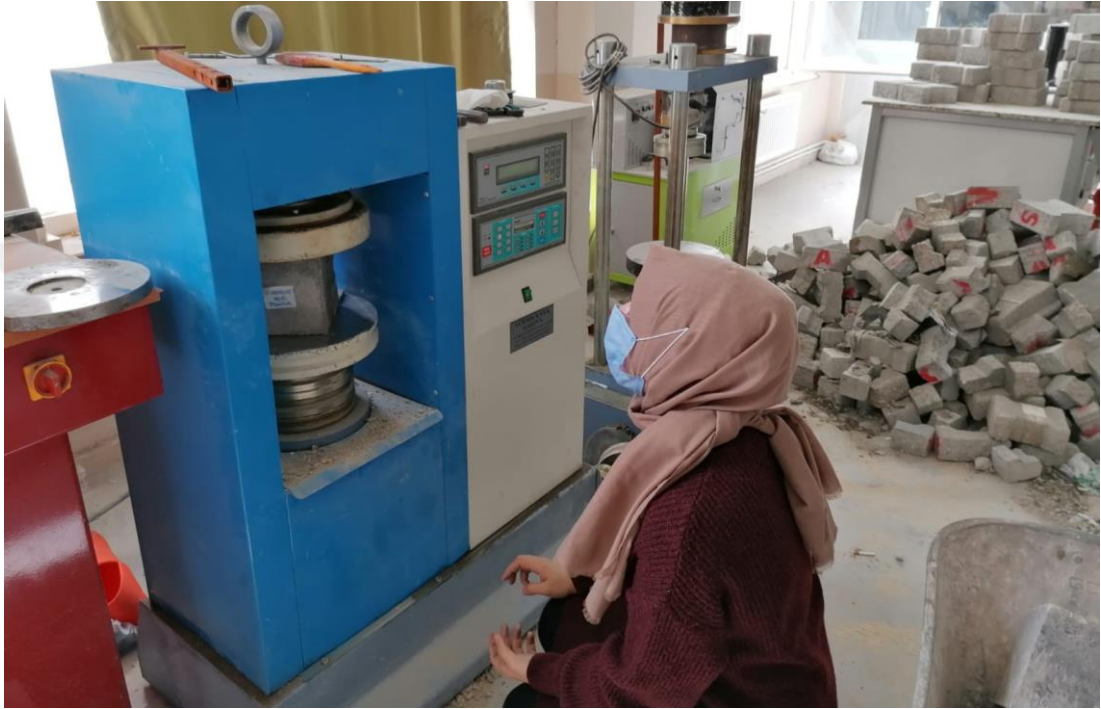
Şekil 3.15. Hidrolik presle basınç dayanımı deneyi.
