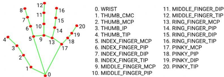
Şekil 3.18. MediaPipe el anahtar noktaları (Samaan vd., 2022)
