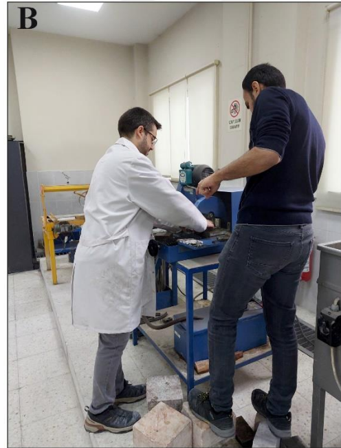
Şekil 3.2 a) Afyon menekşe mermer örneklerinin hazırlamasında karelaj ağların oluşturulması, b) Karelaj ağlara bölünmüş mermerlerin kesim işlemi.
