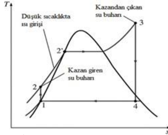
Şekil 2.17 İdeal Rankine çevrimine kazanda düşük sıcaklıkta ısı geçişi
