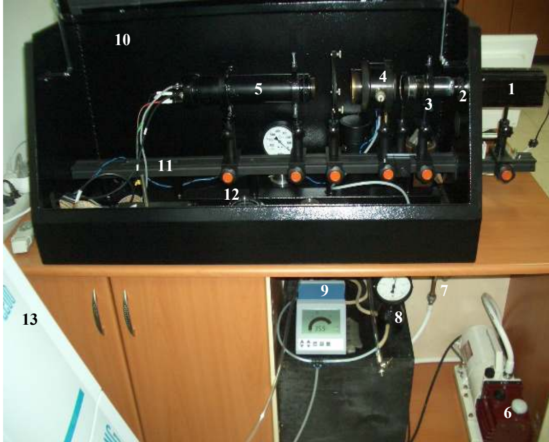
Resim 3.1. YGBY' yi oluşturan deneysel düzeneğin fotoğrafı. Deney düzeneğinin oluşturan elemanlar: 1. Işık kaynağı (halojen lamba), 2. Mercek sistemi, 3. Si filtre, 4. Yarıiletken katotlu gaz boşalma hücresi, 5. Fotoçoğaltıcı, 6. Vakum pompa, 7. Vakum vana, 8. Analog manometre, 9. Dijital manometre, 10. Işık geçirmez optik kutu, 11. Optik kızak, 12. Tutucu, 13. Hidrojen jeneratör.
