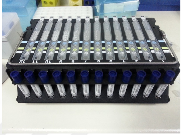
Resim 2: Rafa yerleştirilmiş birimlere ayrılmış reaksiyon kartuşları ve örnek tampon tüpleri
