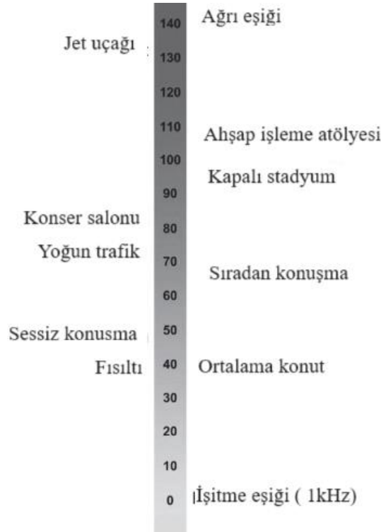
Şekil 4. 4. Yaygın çevresel seslerin ses basınç düzeyi [dB(A)] (Türkçeye çevrilmiştir) [98]
