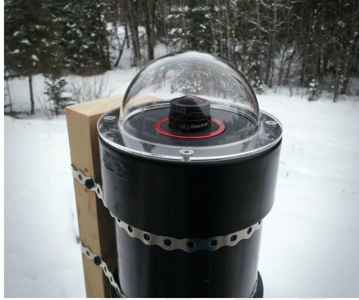
Şekil 2.8. Koruyucu muhafazasına yerleştirilmiş tipik bir All Sky Kamera
