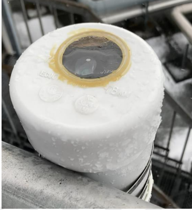
Şekil 2.7. Koruyucu muhafazasına yerleştirilmiş yağış sonrası bir SQM
