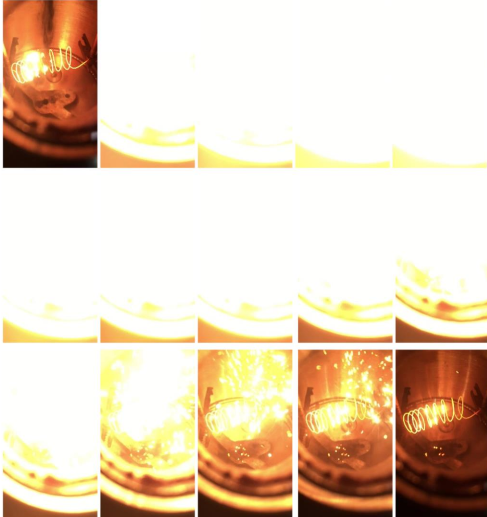
Şekil 6.38. 0,125 g/L Rus Linyit Tozu Patlama Görüntüleri
