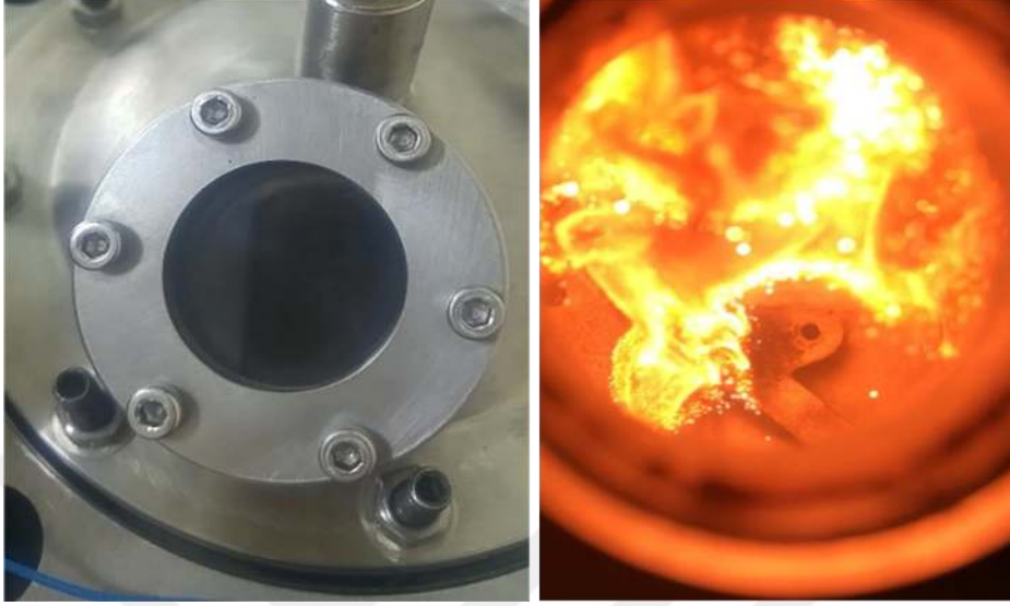
Şekil 5.7. Patlama Küresi Gözlem Penceresi ve Patlama Anı
