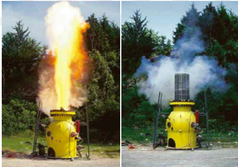
Şekil 4.4. Geleneksel Ventilasyon Teknolojisi ve Alevsiz Ventilasyon Teknolojisi Kıyası (Fike Corporation, USA) (Snoeys, J., ve ark. 2012)
