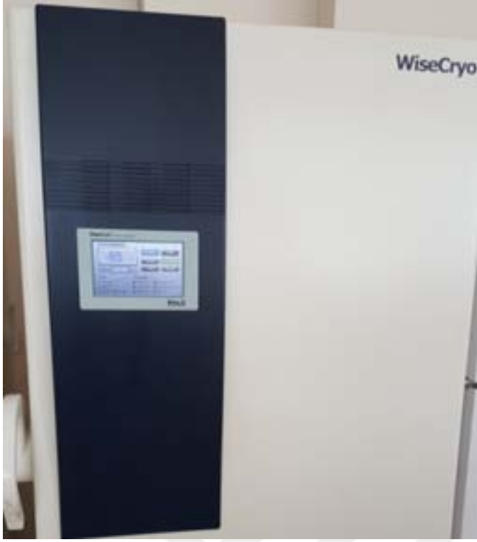
Resim 2.9. -85 C'lik soğutma özelliğindeki soğutucu.
