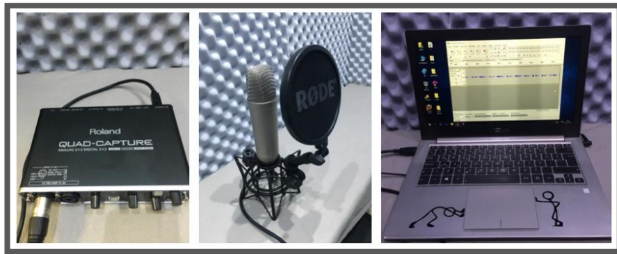
Resim 3.2. Çalışmamızda kullandığımız harici ses kartı, mikrofon ve bilgisayar
