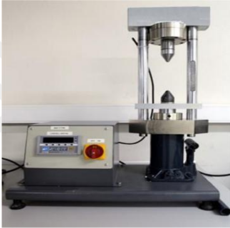
Şekil.3.5. Radial dayanımın yapıldığı nokta yükleme test cihazı
