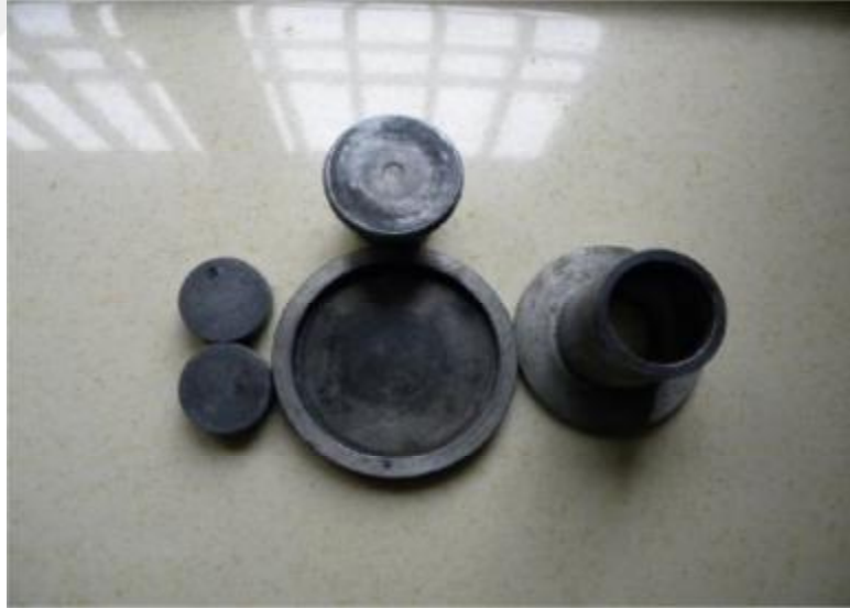
Şekil 3.2. Tufal briketlemesinde kullanılan presleme aparatı
