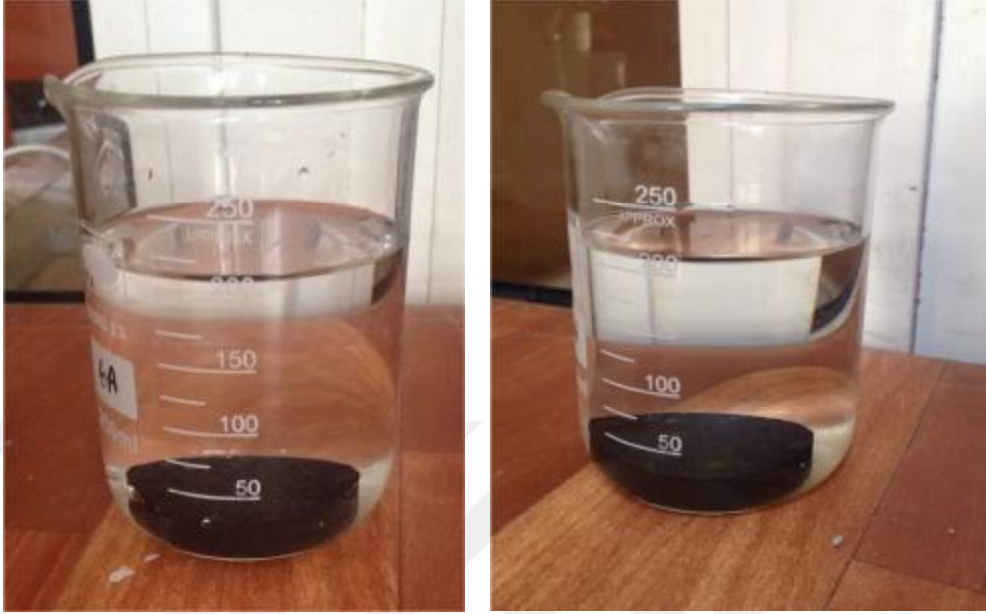
Şekil:3.6.Briketlerin suya dayanımı A) İlk hali B) Son hali
