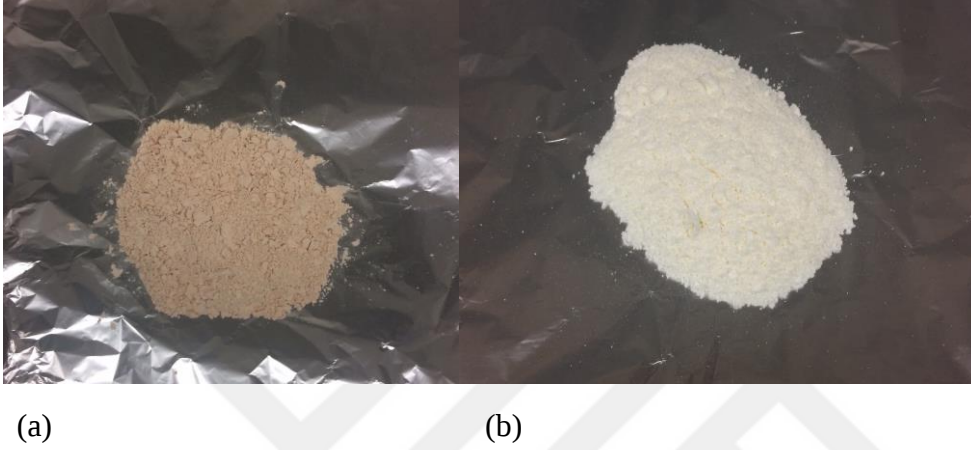
Şekil 3.7. (a) Resorsinol çapraz bağlayıcısıyla üretilmiş MF/CO mikrokapsülü ve (b) Melateks 700 çapraz bağlayıcısıyla üretilmiş HMF/CO mikrokapsülü
