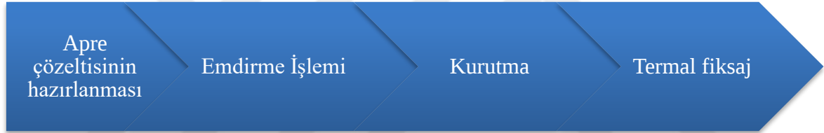
Şekil 3.24. Emdirme İşlemi Proses Akışı
