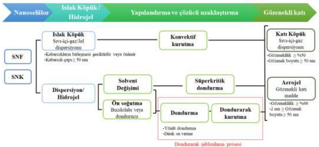
Şekil 2.2 : Nanoselüloz bazlı aerogel ve köpüklerin farklı proseslerle elde edilme yöntemlerinin şematik gösterimi [13].
