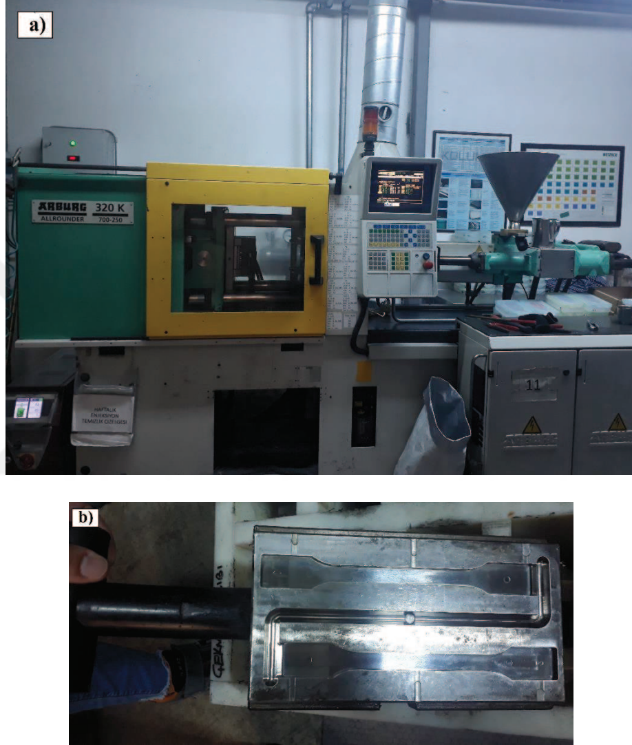
Şekil 3.2 Çalışmada kullanılan a) enjeksiyon makinesi, b) test numune kalıbı
