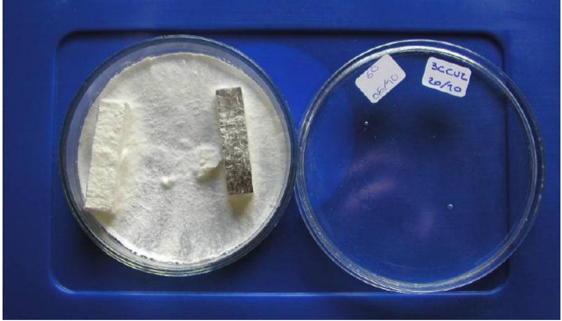
Şekil 8. Isıl işlem görmüş (sağ taraftaki) ve ısıtıl işlem görmemiş (sol taraftaki) ağaç malzeme örneklerinde mantar enfeksiyonundan sonra meydana gelen görüntüler (Esteves ve Pereira, 2009).
