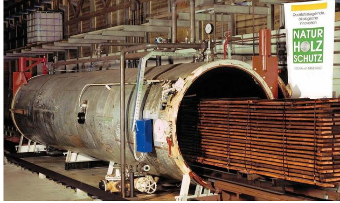
Şekil 4. Reulbach’ teki Oil Heat Treatment fırını ( Menz Holz, Germany).
