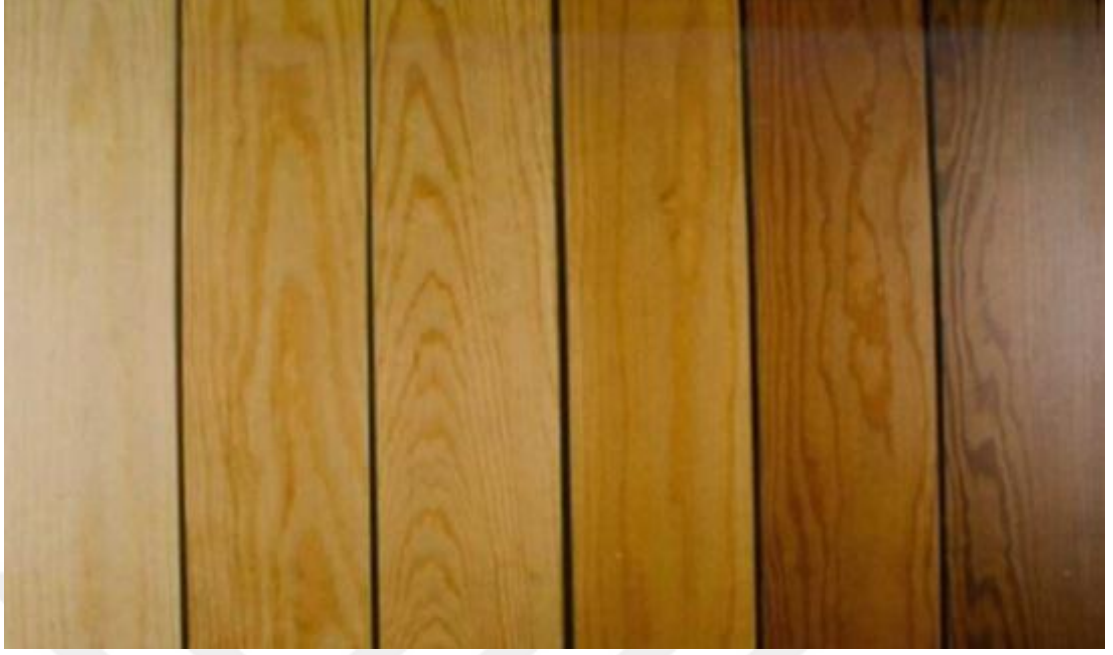
Şekil 7. Isıl işlem görmüş ağaç malzemenin renginde meydana gelen değişim (Anonim, 2006)
