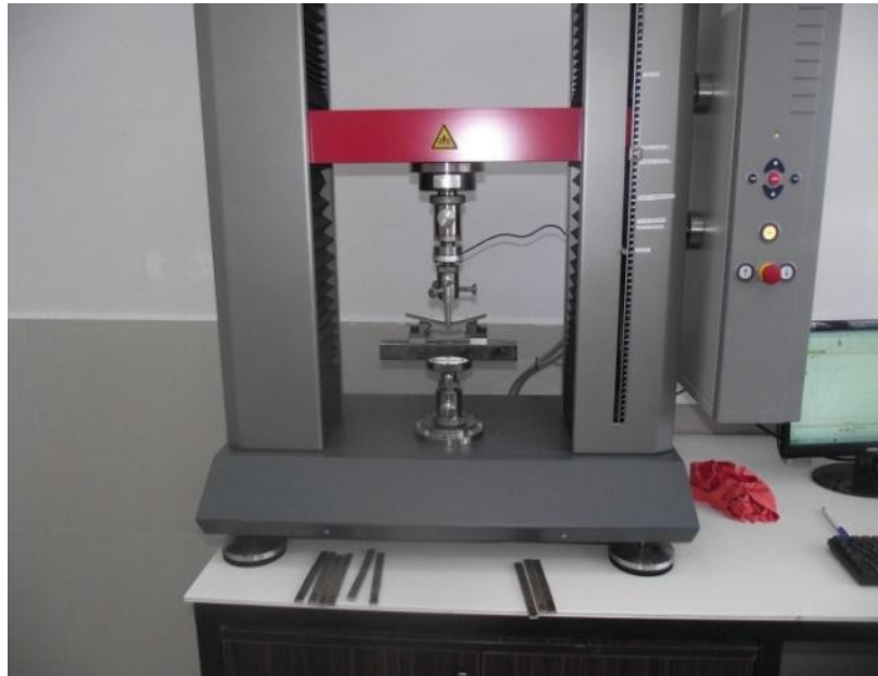
Şekil 14. Eğilme direncine ait test örneği
