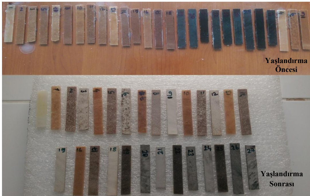
Şekil 19: Yaşlandırma sonrası örneklerin görünümü.
