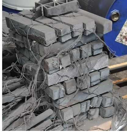
Şekil 3.5. Östemperleme ısı işlemi sonrası numuneler
