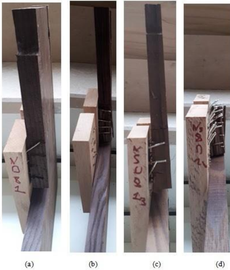
Şekil 30. Isıl işlemlı dişbudak örneklerinden oluşturulmuş çift sıra 8 zımbalı birleştirme yerlerine ait ayrılma biçimlerinin önden görüşleri a) 1 nolu, b) 2 nolu, c) 3 nolu, d) 4 nolu birleştirme yerleri
