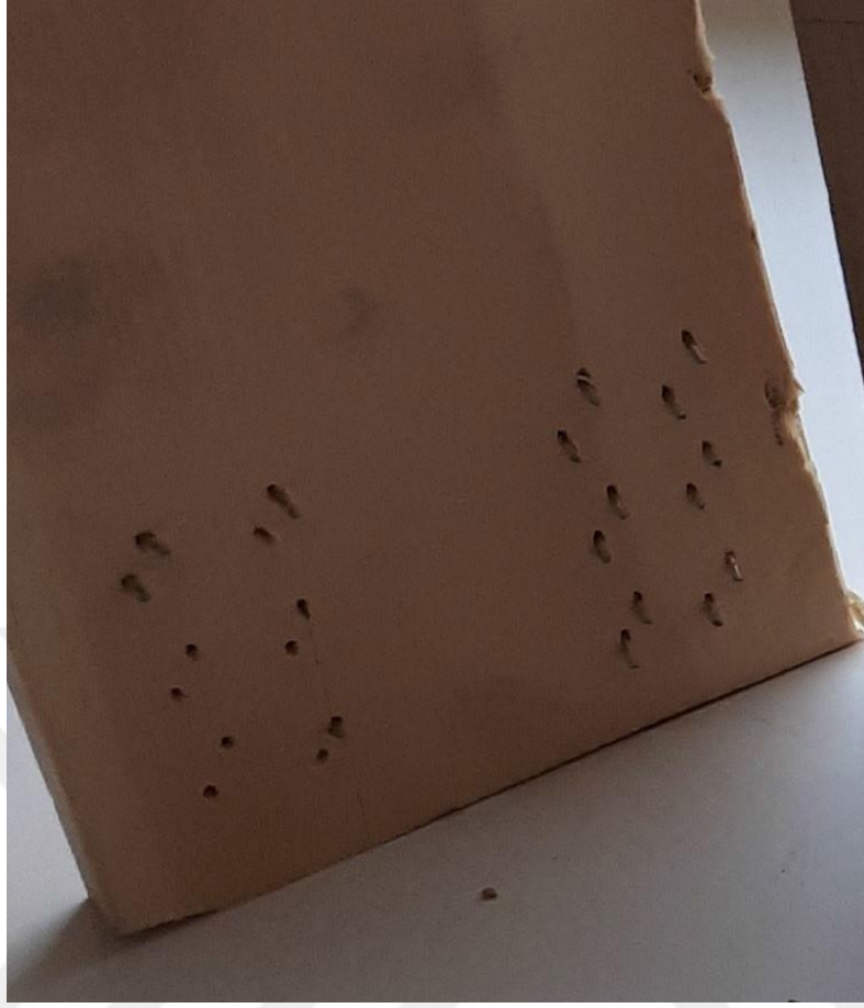
Şekil 18. Zimba malzemesinin devirli yük altında kopması
